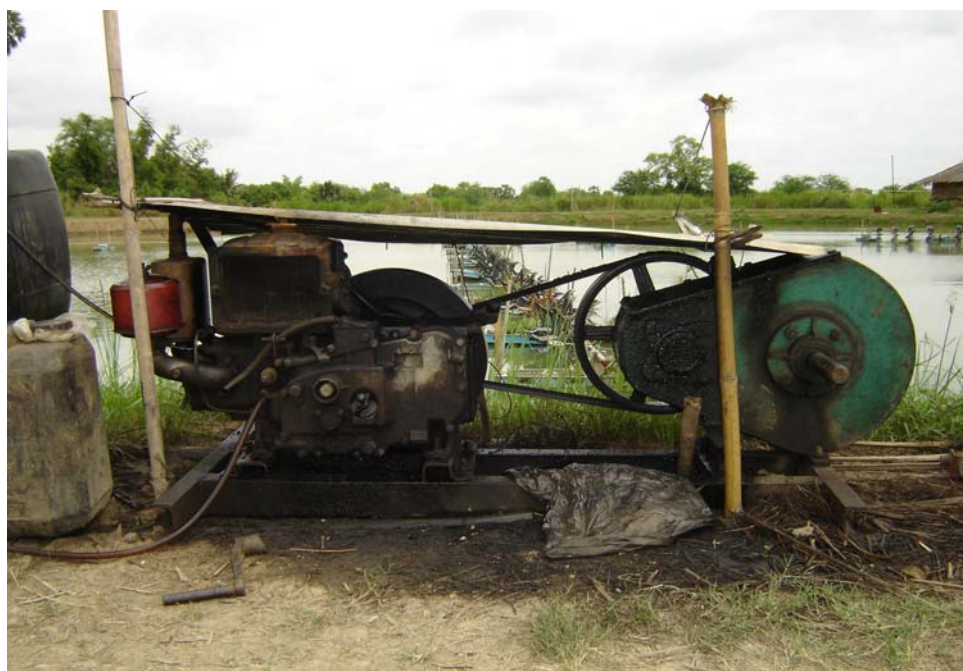
ภาพที่ 4 เครื่องยนต์ขนาด 11 แรงม้า ของการวางเครื่องให้อากาศระบบที่ 1
