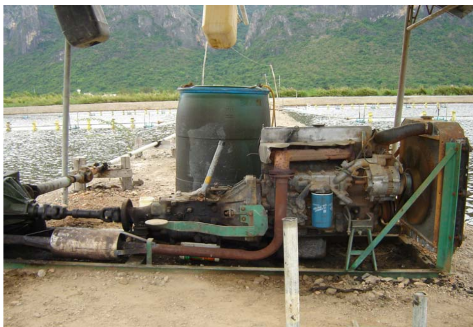
ภาพที่ 6 เครื่องรยยนต์ขนาด 100 แรงม้าของการวางเครื่องให้อากาศระบบที่ 3
