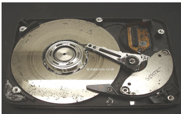
ภาพที่ 1.1 ผลกระทบที่เกิดจากสิ่งปนเปื้อนในฮาร์ดดิสก์ไดรฟ์
