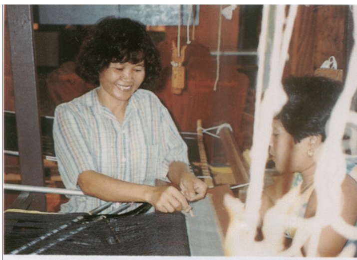
ภาพที่ 14 นำเส้นด้ายยืนที่เรียงเส้นไว้แล้วในข้างต้น ขึ้นหูกสืบต่อจากเส้นยืน ในตะกอ ในกรณีที่ขึ้นหูกเก็บตะกอเป็นครั้งแรกจะสอดเส้นยืนใส่ใน ช่องฟันหวี
