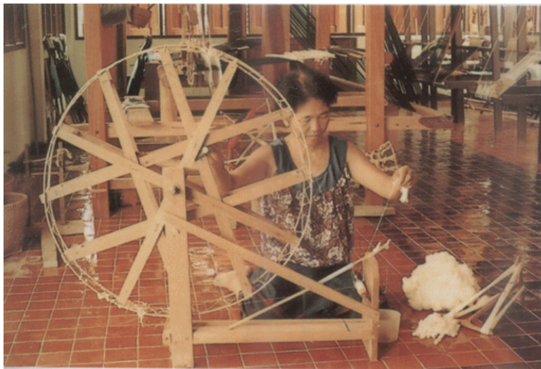
ภาพที่ 11 นำปุยฝ้ายที่ฟูกระจายม้วน เป็นแท่งกลมยาวมาปั่นเป็นเส้น ด้วยเครื่องมือที่เรียกว่า เฝียน ( ไน , หลา )
