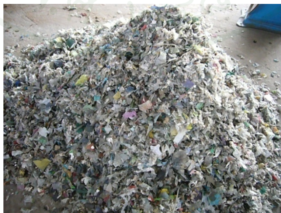
ภาพที่ 10 ขยะที่สามารถเผาไหม้ได้ที่ถูกคัดแยกแล้วและย่อยให้มีขนาดเล็ก
