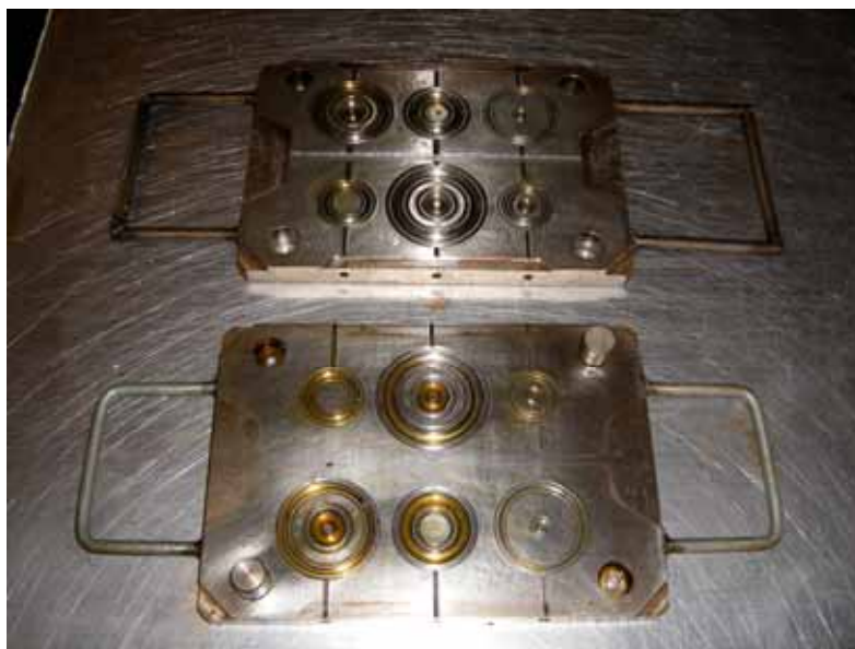
ภาพที่ 39 แม่พิมพ์ผลิตโอริงที่ผลิตและใช้ในการศึกษาการหดตัวในงานวิจัย
