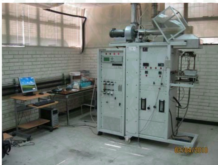
ภาพที่ 4 เครื่องแคลอริมิเตอร์รูปกรวย ของศูนย์วิจัยเพื่อความปลอดภัยจากอัคคีภัย จุฬาลงกรณ์มหาวิทยาลัย บริเวณพื้นที่มหาวิทยาลัยเทคโนโลยีราชมงคล ตะวันออก วิทยาเขตอุเทนถวาย
