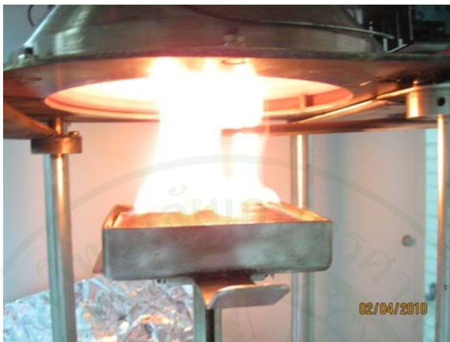
ภาพที่ 21 ชิ้นงานตัวอย่างไม้อัดสักแห้งขณะถูกติดไฟ
