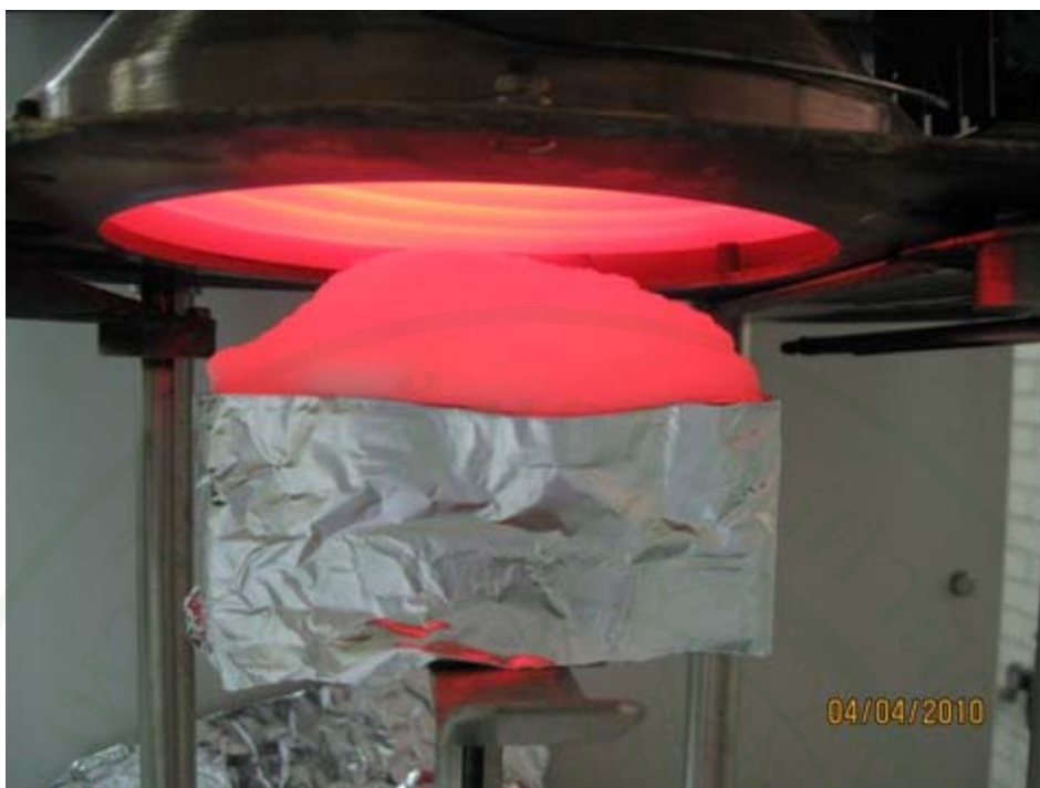
ภาพที่ 34 ชั้นฟองโฟมขยายตัวพองสูงขึ้นเมื่อได้รับความร้อน
