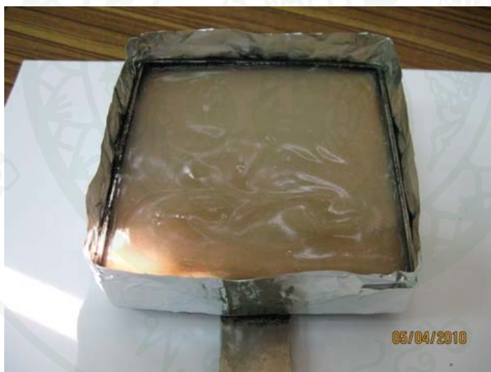
ภาพที่ 26 ชิ้นงานที่ได้รับการเคลือบผิววัสดุด้วยเจลดับเพลิง มีความหนาชั้นเจลประมาณ 5 มิลลิเมตร
