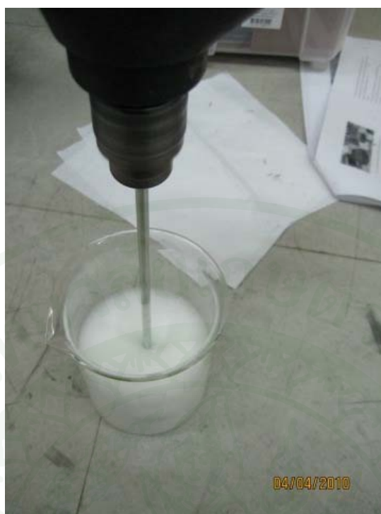
ภาพที่ 22 การตีสารละลายโพลีด้วยเครื่องปั่นความเร็วรอบ 1600 รอบต่อนาที
