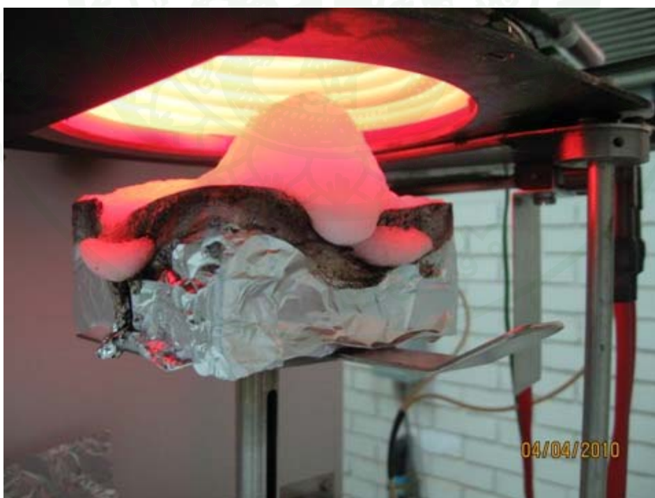
ภาพที่ 35 ชั้นฟองโฟมขยายตัวเมื่อได้รับความร้อนจนพองสูงขึ้นและล้นออกด้านข้าง
