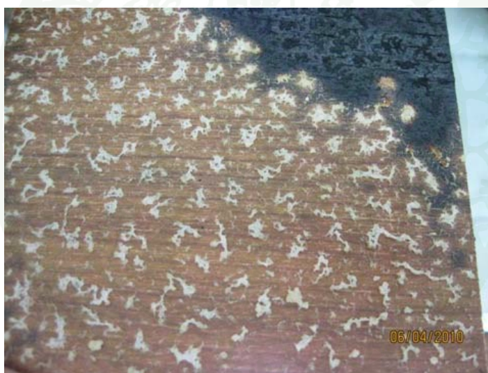
ภาพที่ 36 ภาพระยะใกล้ของผิววัสดุฐานที่เคลือบด้วยเจลดับเพลิง เมื่อเนื้อเจลแห้งหมด ทั้งวัสดุสีขาวกระจายทั่วผิวชิ้นงาน
