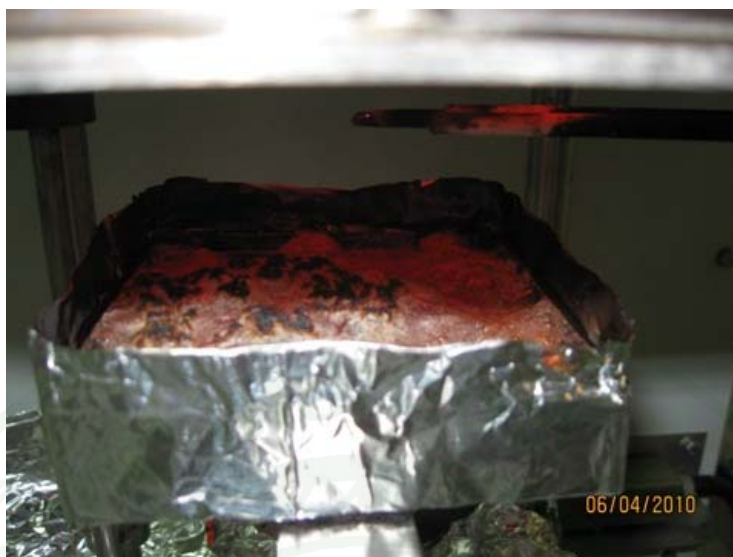
ภาพที่ 37 ชิ้นงานตัวอย่างทดสอบเคลือบด้วยวุ้นผงบุก ขณะได้รับฟลักซ์ความร้อน มีจี๊ดเสียดำ เกิดขึ้นด้านบน
