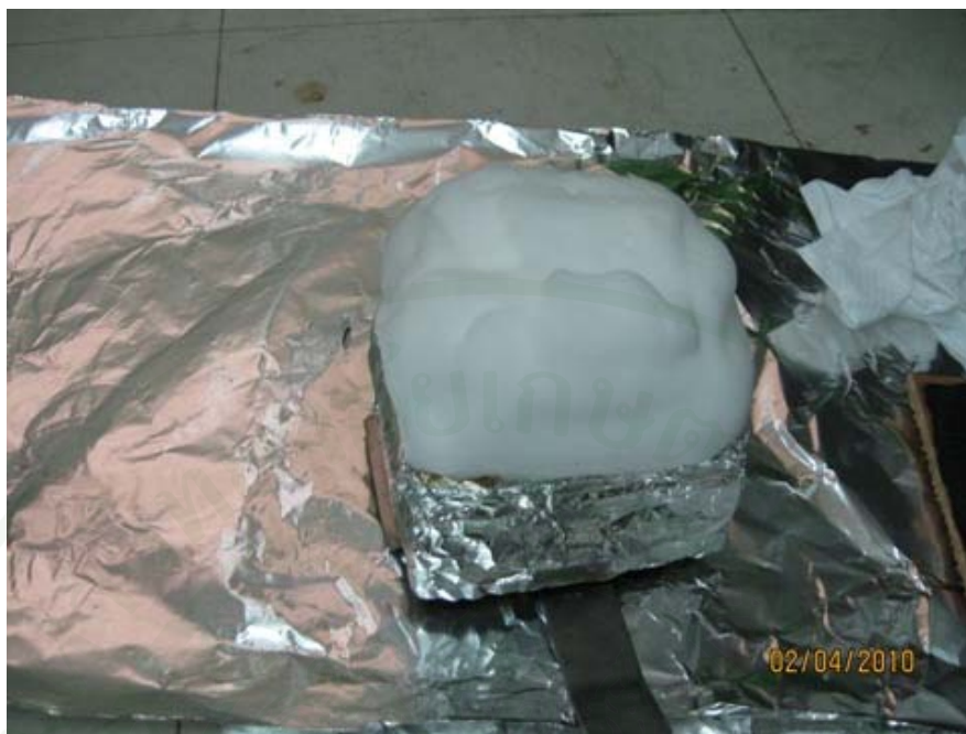
ภาพที่ 24 ชิ้นงานที่ถูกเคลือบด้วยสารดับเพลิงประเภทฟองโฟมมีความสูงประมาณ 4 เซนติเมตร จากผิววัสดุ
