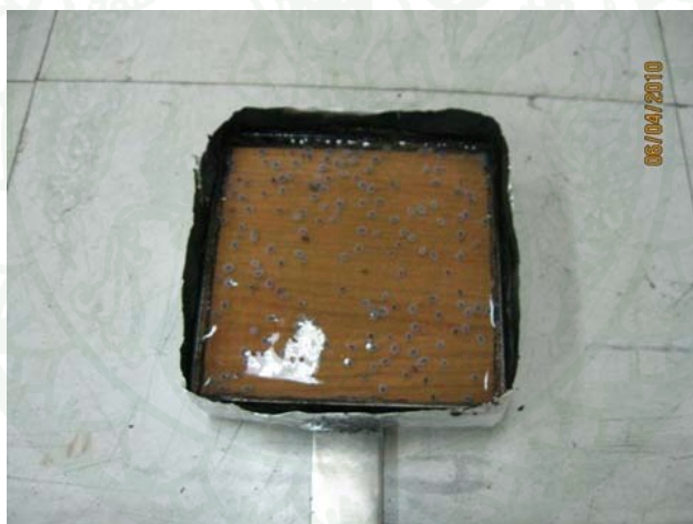
ภาพที่ 30 ชึ้นงานที่เคลือบด้วยฐึ้นจากผงบูกัณและเม็ดแมงลัก มีควมหนาชั้นฐึ้นประมาณ 5 มิลลิเมตร
