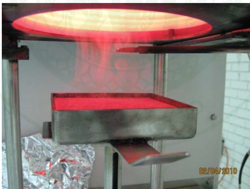
ภาพที่ 20 ชิ้นงานตัวอย่างไม้อัดสีกแห้งเมื่อได้รับฟลักซ์ความร้อนจะคายไอน้ำที่ติดไฟได้ออกมา
