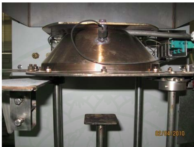
ภาพที่ 5 ส่วนให้ฟลักซ์ความร้อนรูปทรงกรวยของเครื่องแคลอริมิเตอร์รูปกรวย
