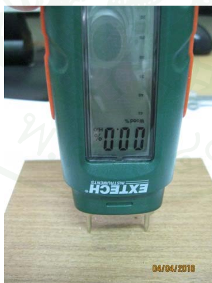
ภาพที่ 15 การวัดความชื้นในชิ้นงานทดสอบด้วยเครื่องวัดความชื้นเนื้อไม้ชนิดแทงของ Extech Instruments รุ่น MO210
