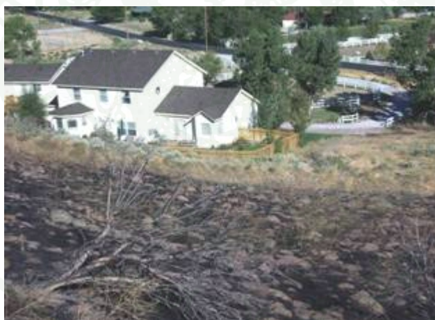
ภาพที่ 3 อาคารและบริเวณโดยรอบที่ได้รับการฉีดป้องกันด้วยวัสดุเจลดับเพลิงที่มีขายในท้องตลาดก่อนที่ไฟป่าจะลามเข้าทำความเสียหาย
