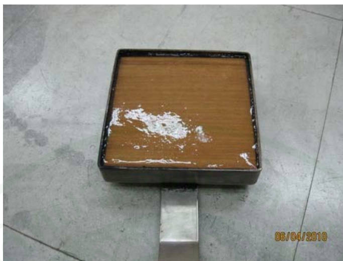
ภาพที่ 28 ชิ้นงานที่เคลือบด้วยวุ้นจากผงบุก มีความหนาชั้นวุ้นประมาณ 5 มิลลิเมตร
