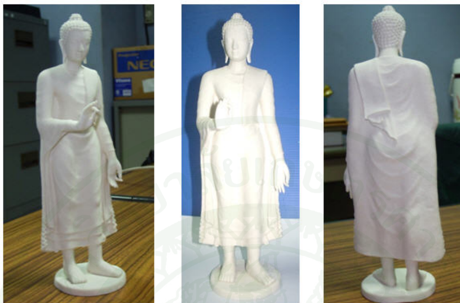
ภาพที่ 63 ชิ้นงานจำลองที่ได้จากกระบวนการทางวิศวกรรมย้อนรอย และ Rapid Proto Type
