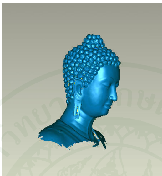
ภาพที่ 32 แสดงรายละเอียด หลังจากที่ได้คำนวณความกลมกลืนของผิว และเชื่อมทั้งสองผิวให้เป็นผิวงานเดียวกันแล้ว
