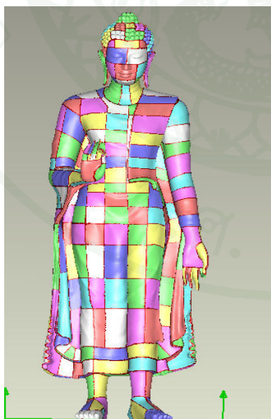
ภาพที่ 50 แสดงรายละเอียดภาพหลังจากทำสร้างเส้นแนว Patch
