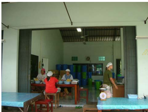
ภาพที่ 35 ร้านมาลี: ไม่มีมาตรการจัดการรองเท้าที่ใช้ในบริเวณผลิตทำให้เสี่ยงต่อการปนเปื้อน เนื่องจากอาคารผลิตเป็นแบบเปิดโล่ง
