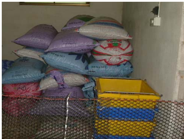
ภาพที่ 21 กลุ่มผู้ผลิตพืชสมุนไพรบ้านเกาะลอย: มีการเก็บรักษาวัตถุดิบที่ใช้ในกระบวนการผลิตไม่เหมาะสม เก็บไว้ในนอกอาคารผลิต วางอยู่บนพื้นโดยตรง และวางรวมกับสิ่งของอื่นๆ ที่ไม่ใช่วัตถุดิบ ทำให้เสี่ยงต่อความชื้น และการปนเปื้อน
