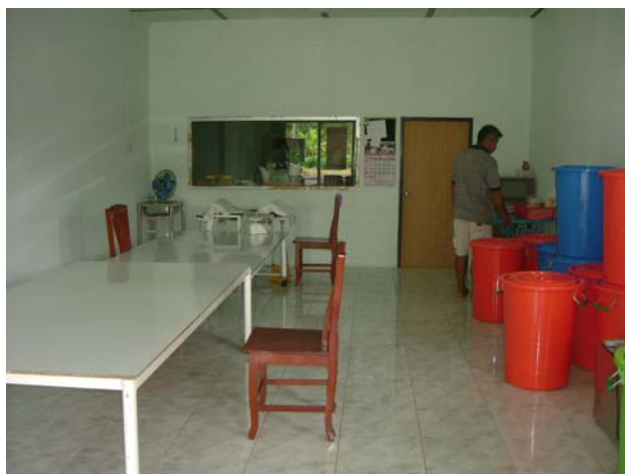
ภาพที่ 22 กลุ่มแม่บ้านเกษตรกรหนองบัวสระกระชาย: ในระหว่างการผลิตอาหารมีการดำเนินการขนย้ายวัตถุดิบ ส่วนผสม ภาชนะบรรจุและบรรจุภัณฑ์ไม่เป็นเส้นตรงตามสายงานการผลิตต้องเดินย้อนกลับไปตามเสี่ยงต่อการปนเปื้อน และมีสิ่งของที่ไม่เกี่ยวข้องกับการบรรจุผลิตภัณฑ์อยู่ในห้องบรรจุ
