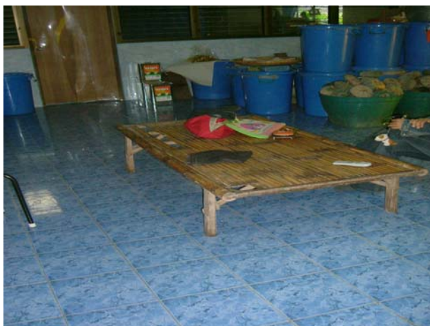
ภาพที่ 19 ร้านอัจฉนาและน้องเอม:เครื่องมือ เครื่องจักรและอุปกรณ์ที่ใช้ในการผลิตมีรอยต่อไม้ เรียบ ขาดต่อการทำความสะอาด และโต๊ะปฏิบัติงานที่สัมผัสกับอาหารมีความสูงไม่ถึง 60 เซนติเมตร
