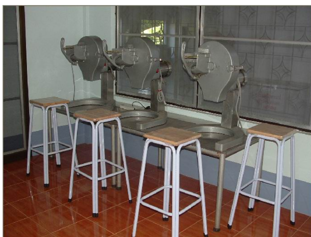
ภาพที่ 63 กลุ่มสตรีอาสาพัฒนาชุมชนตำบลตรอกนอง: การติดตั้งเครื่องมือ เครื่องจักรและอุปกรณ์ที่ใช้ในการผลิตที่สัมผัสกับอาหารมีความสูงที่เหมาะสมโดยสูงมากกว่า 60 เซนติเมตร และอยู่ในสภาพที่ใช้งานได้
