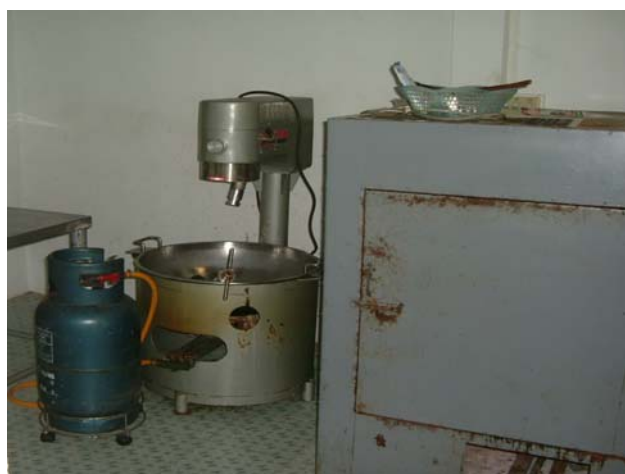
ภาพที่ 18 ร้านแม่สาละ: การติดตั้งเครื่องมือ เครื่องจักรและอุปกรณ์ที่ใช้ในการผลิตอยู่ในตำแหน่งที่ทำความสะอาดยากและไม่เป็นไปตามสายงานการผลิตโดยทำการผลิตในห้องบรรจุ
