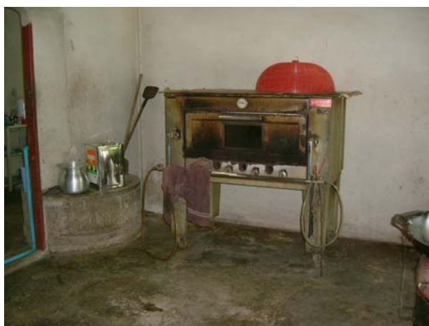
ภาพที่ 16 กลุ่มแม่บ้านเกษตรหนองบัวท่าใหม่: เครื่องมือ เครื่องจักรและอุปกรณ์ที่ใช้ในการผลิตเลี้ยงต่อการเป็นสนิม เป็นพิษ พื้นอาคารผลิตสกปรก
