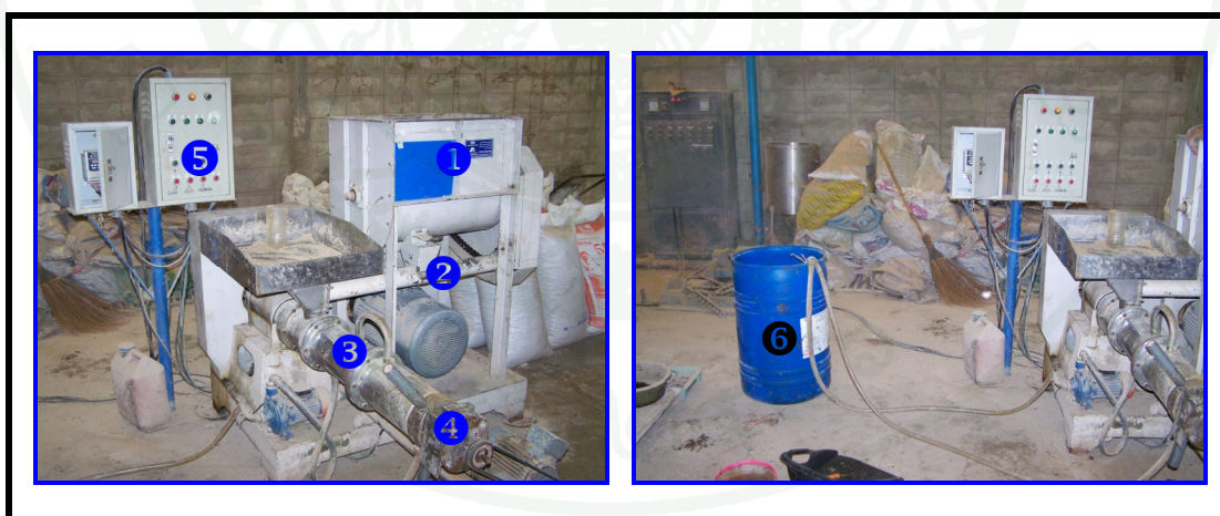
ภาพผนวกที่ ค 1 เครื่องเอ็กซ์ทรูดที่ใช้ในการทดลองพร้อมองค์ประกอบ
