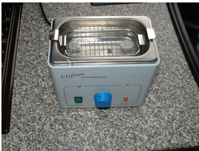
ภาพที่ 8 เครื่อง HIU หรือคลื่นอัลตราโซนิกแบบอ่าง
