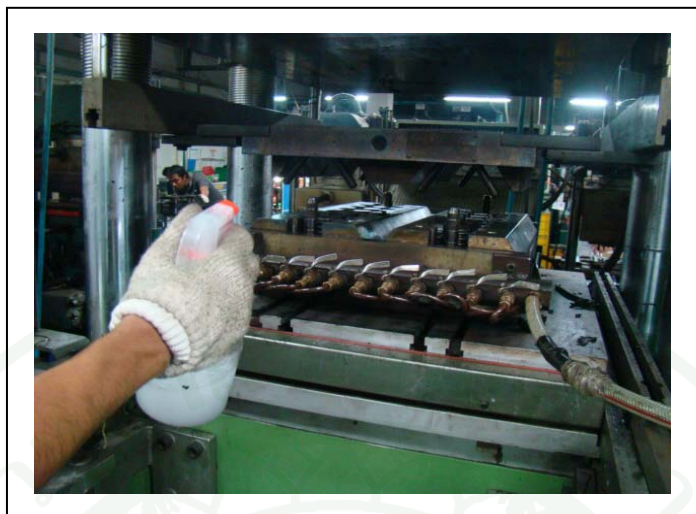
ภาพผนวกที่ ข5 การฉีดน้ำยาเคมีที่เบ้าแม่พิมพ์ก่อนแม่พิมพ์ปิด เพื่อปลดชิ้นงานออกได้ง่ายและรักษาอุณหภูมิเมื่อแม่พิมพ์เปิด
