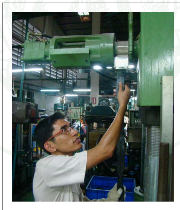
ภาพผนวกที่ ข6 การป้อนแถบยางเข้ากระบอกรีด
