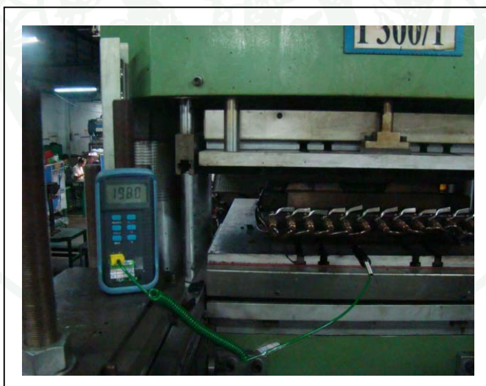
ภาพผนวกที่ ข2 การวัดอุณหภูมิแม่พิมพ์ฉีดขึ้นรูปผลิตภัณฑ์อย่างตัวอย่างกรณีศึกษาขณะแม่พิมพ์ปิด เพื่อฉีดขึ้นงาน
