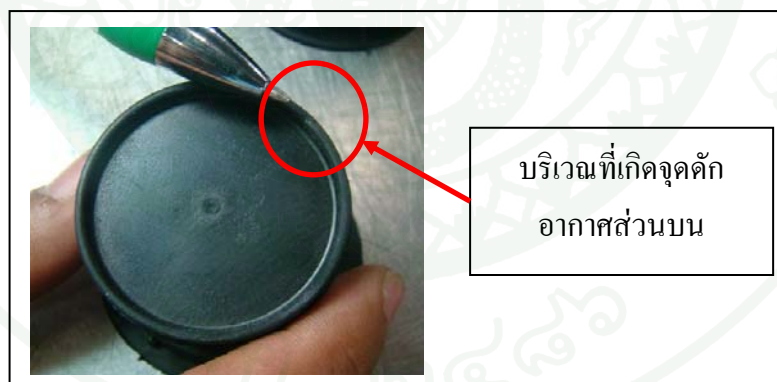
ภาพที่ 23 การเกิดจุดดักอากาศในบริเวณส่วนบนของผลิตภัณฑ์ข้างตัวอย่าง
