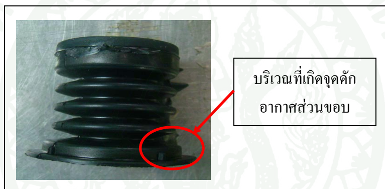
ภาพที่ 25 การเกิดโพรงอากาศในบริเวณส่วนขอบของผลิตภัณฑ์อย่าง
