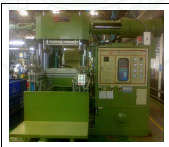
ภาพที่ 21 เครื่องฉีดขึ้นรูปผลิตภัณฑ์ยางแนวตั้งยี่ห้อ Lin Cheng รุ่น IRH-450 S
