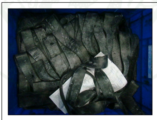
ภาพที่ 15 ยางคอมพาวด์ที่ใช้ในการขึ้นรูปคือ EPDM ความแข็ง 50 Shore A
