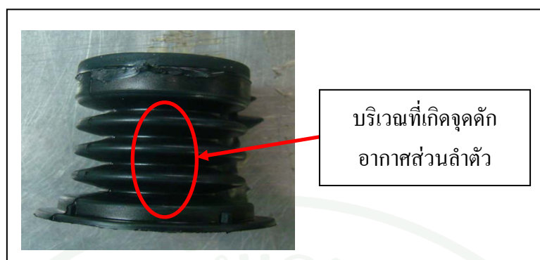
ภาพที่ 24 การเกิดจุดดักอากาศในบริเวณส่วนลำตัวของผลิตภัณฑ์อย่าง
