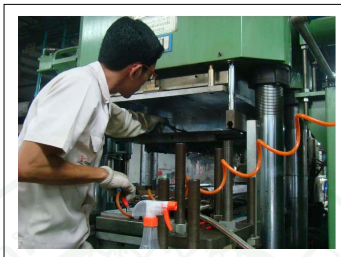
ภาพผนวกที่ ข3 แม่พิมพ์ฉีดเปิดออกเพื่อนำทางวิ่งและเศษยางออกจากแผ่นบนของแม่พิมพ์ (Upper Plate)
