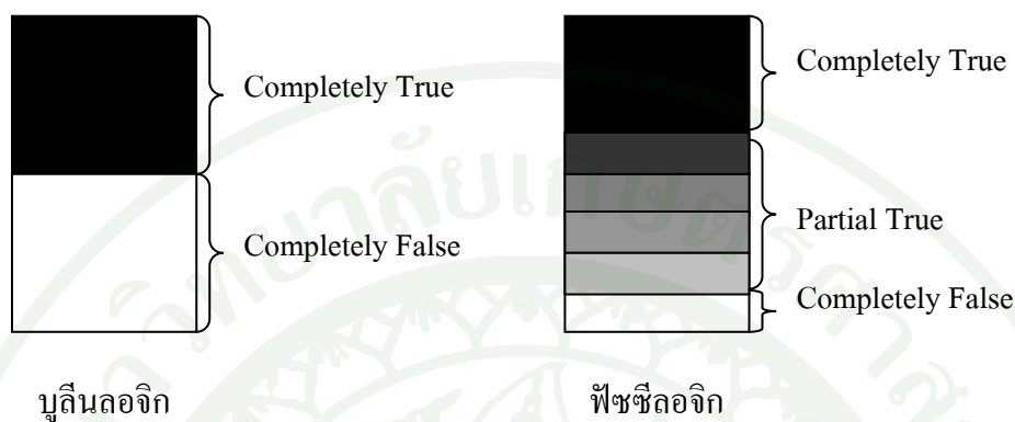
ภาพที่ 3 เปรียบเทียบตรรกะแบบจริง (บูลีนลอจิก) และตรรกะแบบฟัซซี (ฟัซซีลอจิก)
