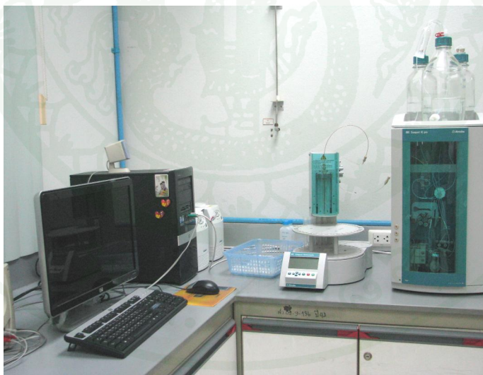
ภาพที่ 13 เครื่อง ion chromatography model metrohm intelligent 882
