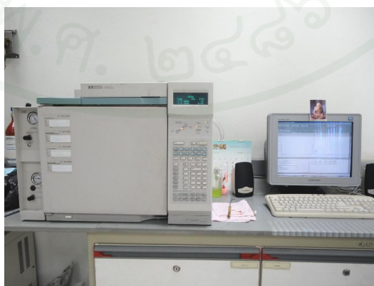
ภาพที่ 12 เครื่อง gas chromatography hewlett packard model HP 6890 series GC system
