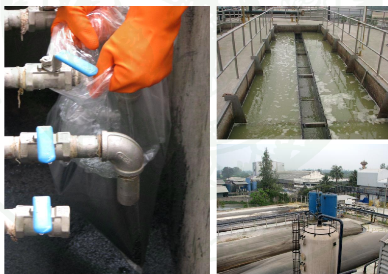
ภาพที่ 19 ลักษณะจุดเก็บตัวอย่างระบบบำบัดน้ำเสียแบบ UASB โรงงานแปรงมันสำปะหลัง-แปรงมัน คัดแปรงและแปรงมันแปรรูป บริษัท อุตสาหกรรมแปรงมันบ้านโป่ง (ภาพเล็กด้านขวา) และลักษณะตะกอนตัวอย่าง (ภาพใหญ่อด้านซ้าย)
