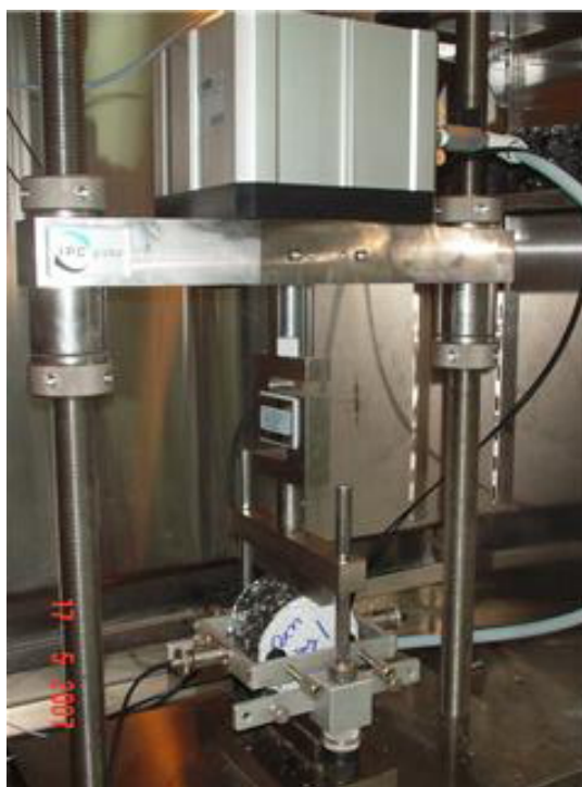
ภาพผนวกที่ 17 เครื่องมือทดสอบ Universal Testing Machine (UTM-5P) ติดตั้งอุปกรณ์ ทดสอบ Static Indirect Tensile
