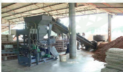
ภาพที่ 19 เครื่องอัดบล็อกประสานระบบไฮดรอลิกใช้ไฟฟ้า
