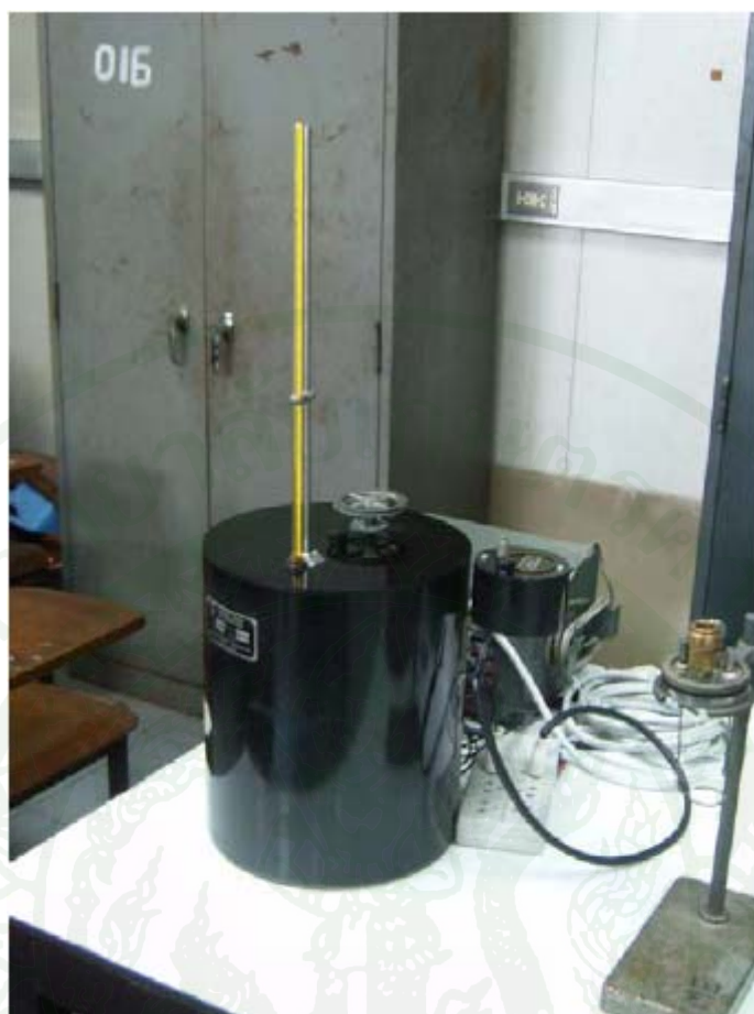
ภาพที่ 28 แสดงส่วนประกอบภายนอกของบอมบ์แคลอรีมิเตอร์
