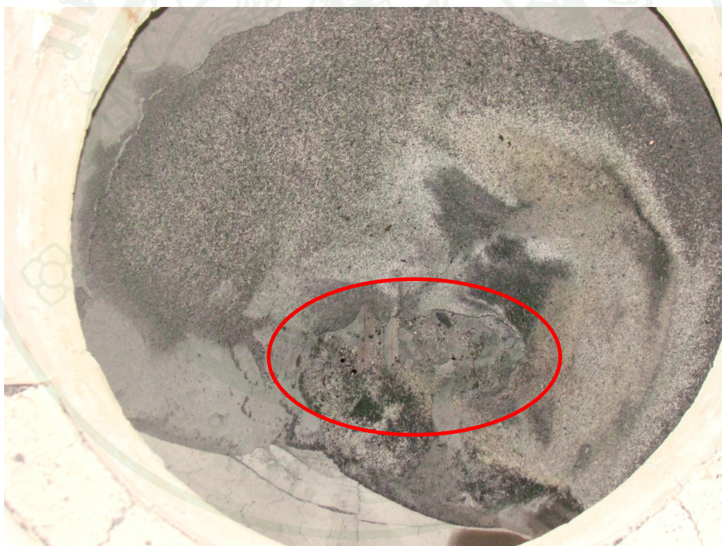
ภาพที่ 42 แสดงลักษณะการเป็นรูของถ่านชาร์ที่ตะแกรงเบด
