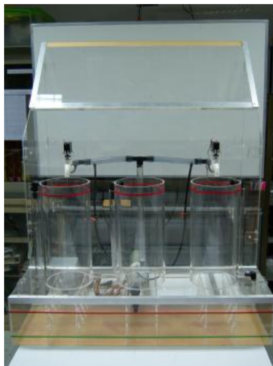
ภาพผนวกที่ จ11 ชุดกระบวนการระดับแบบ interacting 3 ถัง
