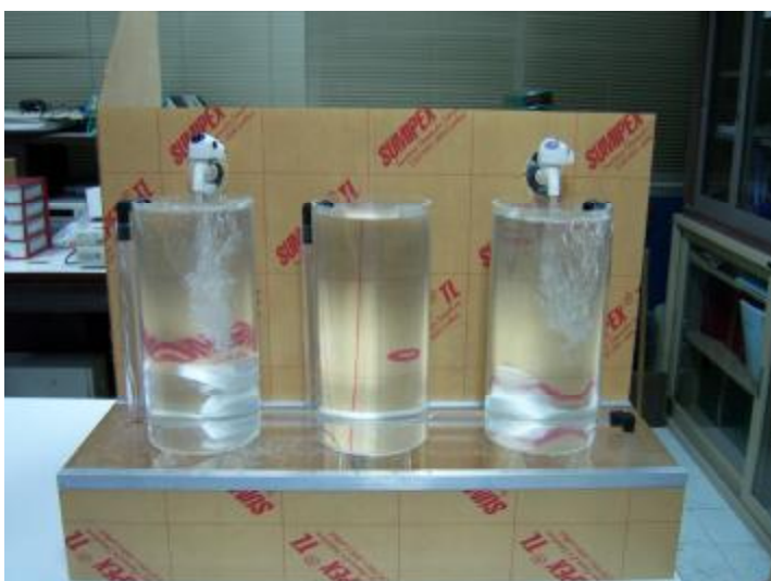
ภาพผนวกที่ ๑๐ การทดสอบการทำงานของกระบวนระดับแบบ interacting 3 ถึง ที่สร้างขึ้น
