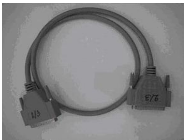
ภาพผนวกที่ ข4 สายสัญญาณในการเชื่อมต่อระหว่างการ์ดกับหัวต่อ
