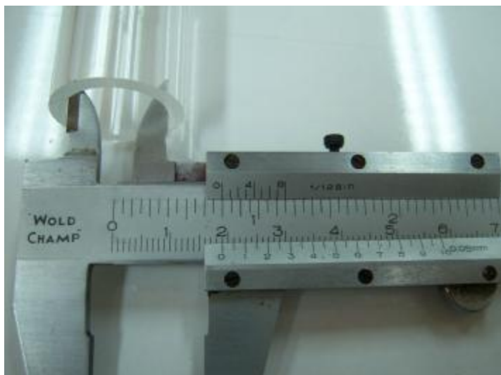
ภาพผนวกที่ ๑๕ ขนาดของท่อที่ใช้เชื่อมต่อระหว่างถัง
