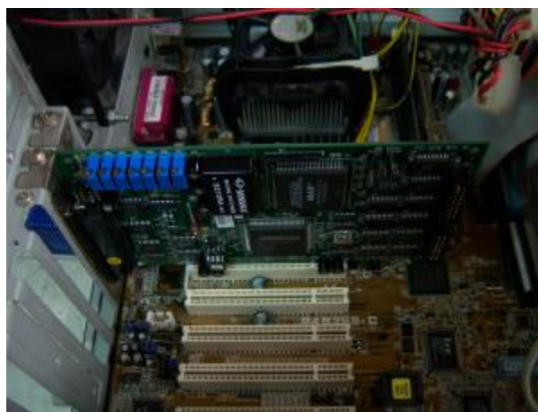
ภาพผนวกที่ ข1 เครื่องคอมพิวเตอร์ที่มีช่องเสียบการ์ดชนิด PCI
