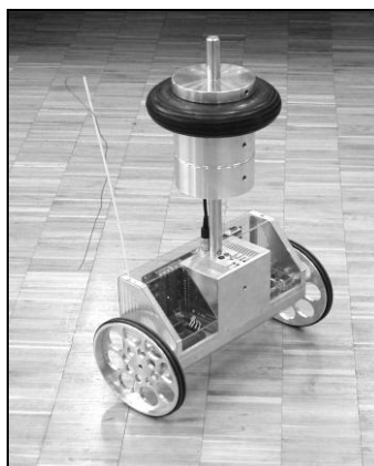
ภาพที่ 6 หุ่นยนต์สองล้อ JOE: a mobile, inverted pendulum
