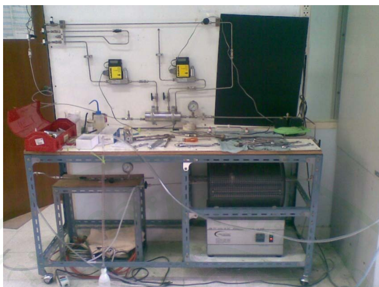
ภาพที่ 10 เครื่องมือวัดการแพร่ของก๊าซเดี่ยวและก๊าซผสมผ่านเมมเบรน
