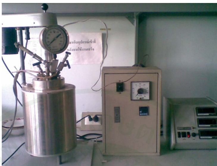
ภาพที่ 6 เครื่องปฏิกรณ์ไฮโดรเทอร์มัล พร้อมเครื่องควบคุมอุณหภูมิ และความเร็วรอบ รุ่น 4561 M
