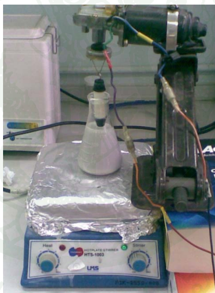
ภาพที่ 7 เครื่องอุปกรณ์ชุบเคลือบ และ อุปกรณ์ชุบปั่นเคลือบ (Dip-coating and Spin-coating)
