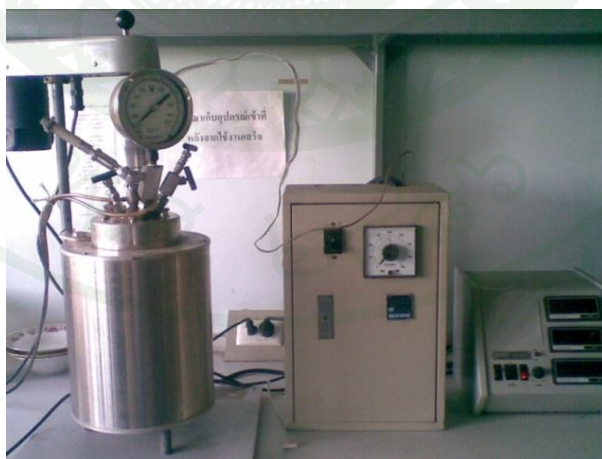
ภาพที่ 8 ชุดเครื่องปฏิกรณ์ไฮโดรเทอร์มัลพร้อมเครื่องควบคุมอุณหภูมิและความเร็วรอบ
