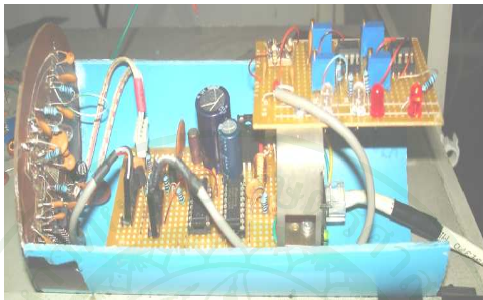
ภาพที่ 64 แสดงชุดอุปกรณ์ตัวรับสัญญาณแสง (Receiver Module) ที่ได้สร้างขึ้น
