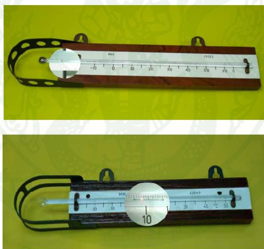
ภาพที่ 23 เทอร์โมมิเตอร์วัดอุณหภูมิสูงสุด (บน) และเทอร์โมมิเตอร์วัดอุณหภูมิต่ำสุด (ล่าง)
