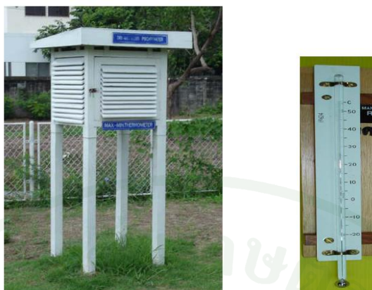
ภาพที่ 22 เรือนเทอร์โมมิเตอร์ (ซ้าย) และเทอร์โมมิเตอร์ธรรมดา (ขวา)
