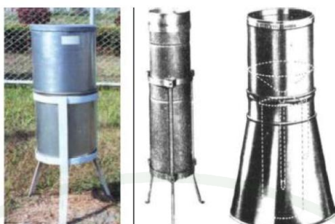
ภาพที่ 25 ถังวัดฝนบนและกรวยรองรับน้ำฝน
