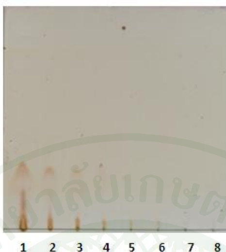
ภาพที่ 37 แสดงผล TLC ของสับสเตรท AB-ald มาตรฐาน โดยช่องที่ 1-8 คือ สับสเตรท AB-ald มาตรฐาน ปริมาณ 13.07 6.53 3.27 1.63 0.82 0.41 0.20 และ 0.10 มิลลิกรัม ตามลำดับ
