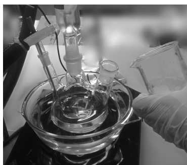
ภาพที่ 30 สารละลายผสมระหว่างโพแทสเซียมไฮดรอกไซด์กับเมทานอลถูกเติมในไบโอดีเซล
