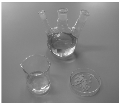
ภาพที่ 28 สารเคมีที่ใช้ในการผลิตไบโอดีเซลจากน้ำมันสบู่ดำ (เมทานอล น้ำมันสบู่ดำ และ โพแทสเซียมไฮดรอกไซด์)
