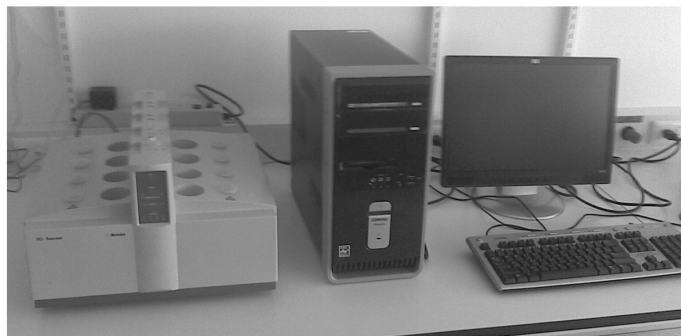
ภาพที่ 33 เครื่อง Rancimat และคอมพิวเตอร์สำหรับประมวลผล
