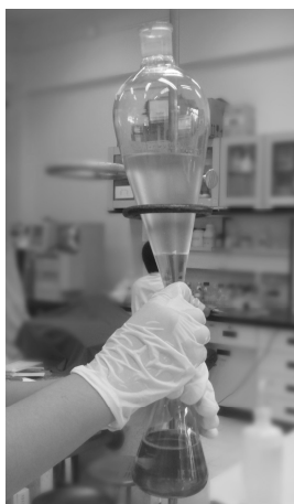
ภาพที่ 31 การแยกกลีเซอรอลออกจากไบโอดีเซล
