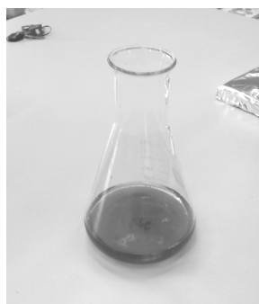
ภาพที่ 42 จุดยุติการไทเทรต สารละลายเปลี่ยนเป็นสีชมพูจาง ๆ คงที่ ประมาณ 30 วินาที
