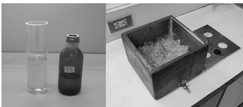
ภาพที่ 36 ตัวอย่างไบโอดีเซลในหลอดแก้วทดสอบและอุปกรณ์ให้ความเย็น
