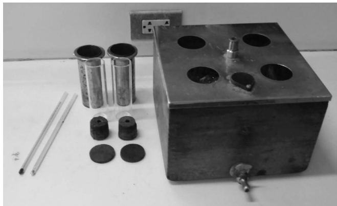
ภาพที่ 35 อุปกรณ์และเครื่องมือที่ใช้ทดสอบจุดหมอกควันและจุดไหลเท
