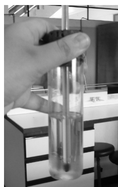
ภาพที่ 38 จุดหมอกควันของไบโอดีเซลซึ่งเริ่มปรากฏในไบโอดีเซล
