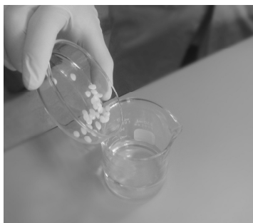
ภาพที่ 29 การเติมโพแทสเซียมไฮดรอกไซด์ในเมทานอล
