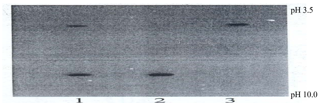
ภาพที่ 4 แสดงค่า pI ของฮีโมโกลบินจากปลา G. unicolor (เลนที่ 1) ฮีโมโกลบินกลุ่มแคโรติก (เลนที่ 2) ฮีโมโกลบินกลุ่มแอนโอดิก (เลนที่ 3) ด้วยเทคนิคไอโซอิเล็กทริกโฟกัสซิง แอมโฟไลต์ pH 3.5 - 10.0 ฮีโมโกลบินได้จากการทำให้บริสุทธิ์โดยใช้เทคนิคโครมาโทกราฟีชนิด DEAE – เซลลูโลส (DEAE- cellulose)
