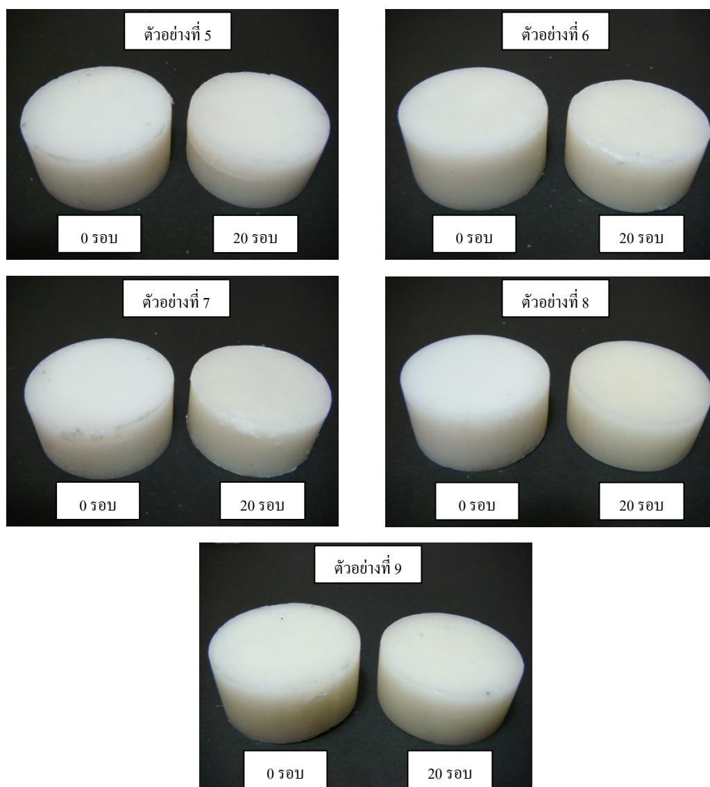
ภาพที่ 66 ผลิตภัณฑ์ shape stabilized PCM ตัวอย่างชุดที่ 2 ก่อนและหลังการใช้งาน 20 รอบ
