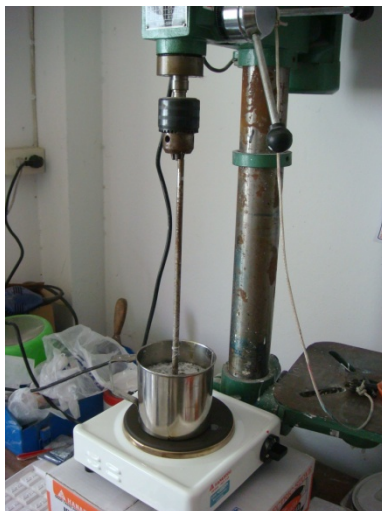
ภาพที่ 25 ชุดอุปกรณ์ประกอบด้วย ถ้วยสเตนเลส เครื่องปั่นไฟฟ้าและอุปกรณ์ให้ความร้อน
