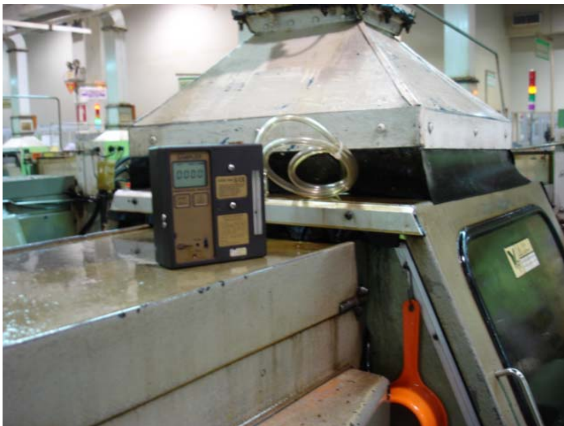
ภาพที่ 17 แสดงการตั้งเครื่องวัดปริมาณละอองน้ำมันที่เครื่องจักร
