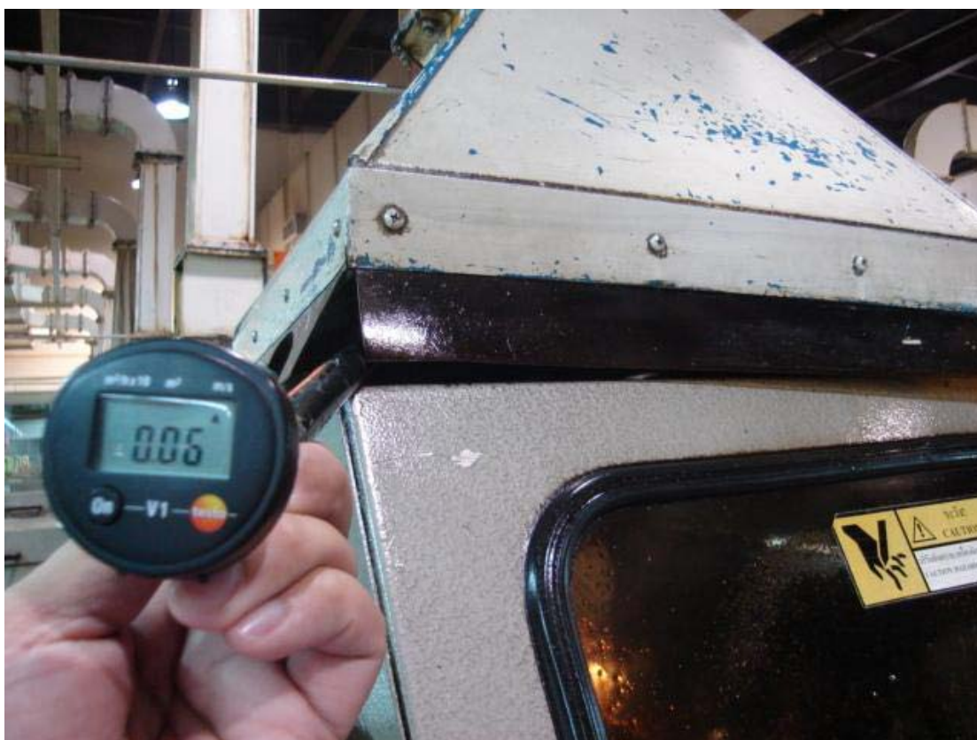
ภาพที่ 21 แสดงการตรวจวัดความเร็วลมที่เกิดจากกระบวนการทำงานของเครื่องจักร
