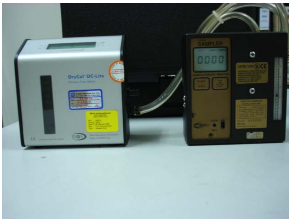
ภาพที่ 15 การต่อเครื่องเก็บตัวอย่างอากาศกับเครื่อง Drycal
