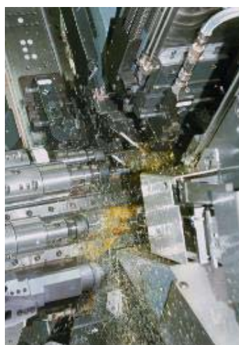
ภาพที่ 6 แสดงการฟุ้งกระจายของละอองน้ำมันที่จุดตัดเจาะชิ้นงาน
