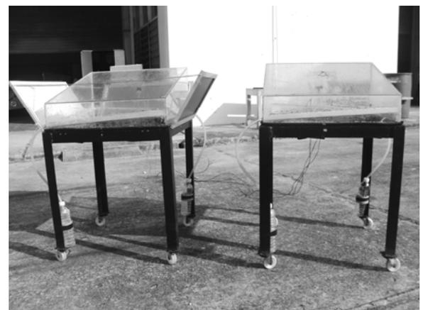
รูปที่ 6 การทดลองกลั่นน้ำทะเลด้วยรังสีอาทิตย์แบบมีแผ่นสะท้อนรังสี และไม่มีแผ่นสะท้อนรังสี
