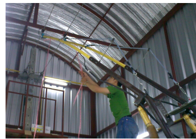
รูปภาพที่ 2 แสดงการใช้คนชักโยงแขนรับกระแสไฟฟ้าด้วยสายส่งของรถโตลลี่บัส
