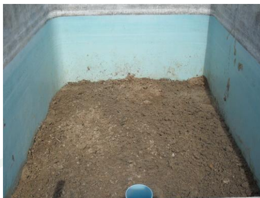
ภาพผนวกที่ ค1 บ่อทดลองขนาด 1.5x2.5x1.0 เมตร ที่ใส่ดินร่อนพื้นบ่อสูงประมาณ 20 เซนติเมตร
