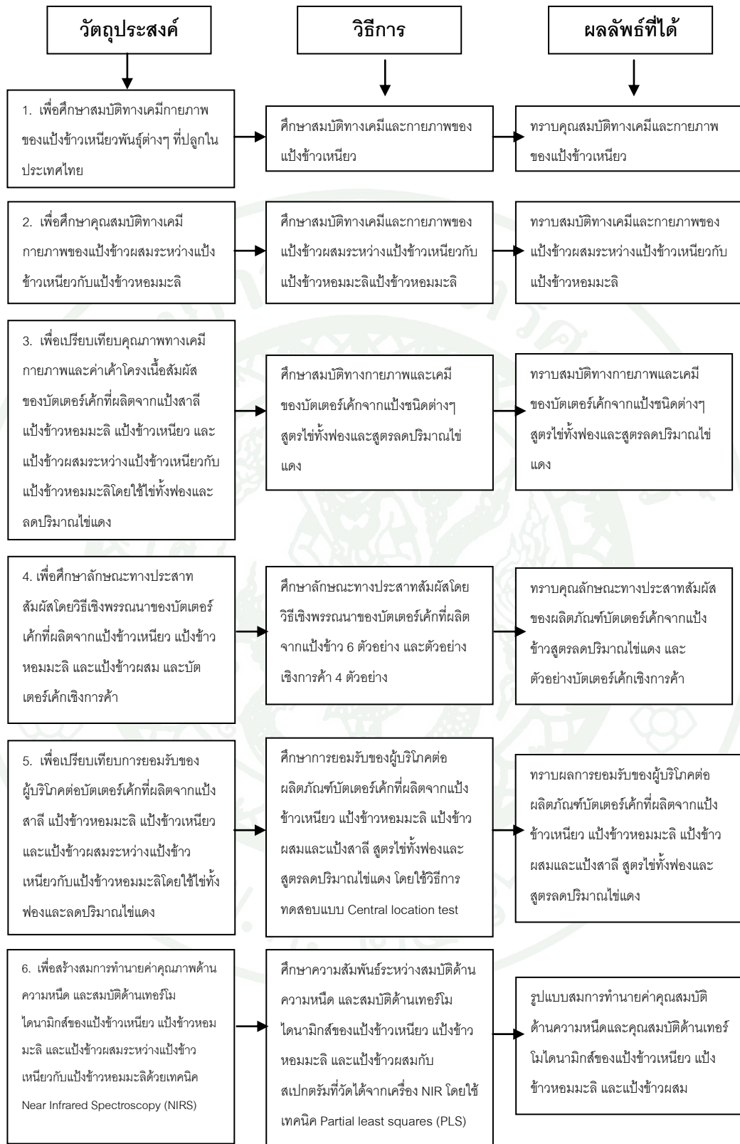
ภาพที่ 8 ขอบเขตการศึกษาศสมบัติทางเคมีกายภาพของแป้งข้าวเหนียวและแป้งข้าวผสมระหว่างแป้งข้าวเหนียวกับแป้งข้าวหอมมะลิและการนำไปใช้ประโยชน์ในผลิตภัณฑ์บัตเตอร์เค้ก
