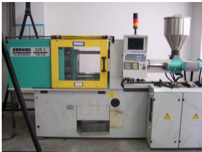
ภาพที่ 33 เครื่องฉีดขึ้นรูปที่ใช้ในงานวิจัย
