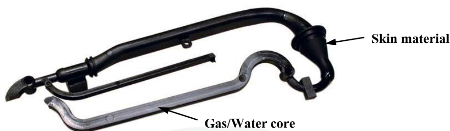
ภาพที่ 26 ลักษณะผลิตภัณฑ์จากกระบวนการฉีดขึ้นรูปแบบใช้น้ำหรือก๊าซช่วย
