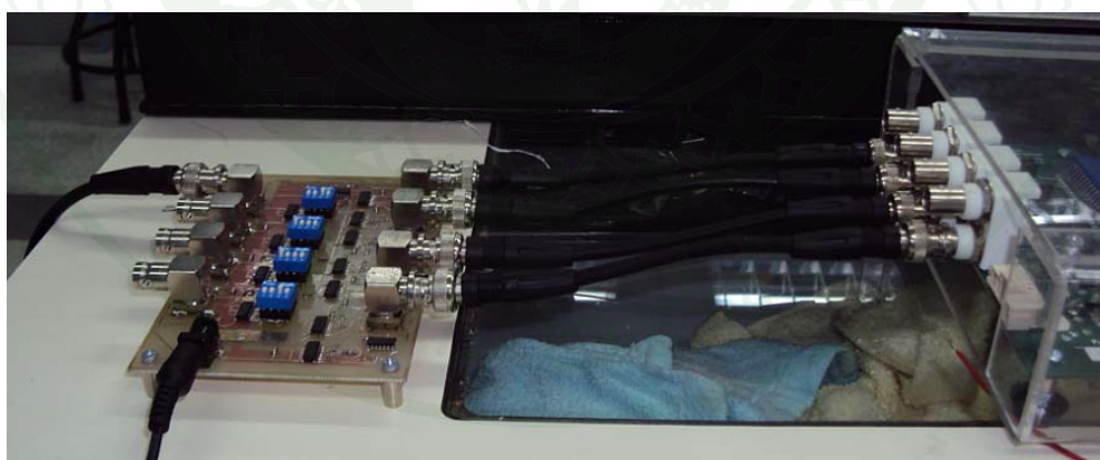
ภาพที่ 32 การติดตั้งวงจรตรวจนับคู่โฟตอนที่เกิดขึ้นพร้อมกันเข้ากับเอาต์พุตของ SPCMs
