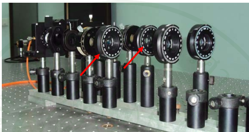
ภาพที่ 23 การติดตั้งแผ่นครึ่งคลื่นบนแกนออลูมิเนียม
