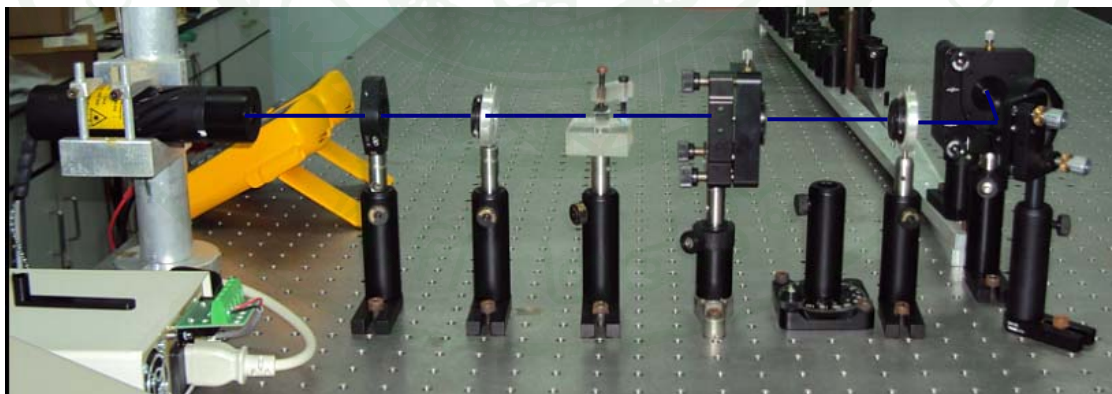
ภาพที่ 12 ลำแสงถูกโฟกัสที่ผลึก BBO มีขนาดเส้นผ่านศูนย์กลางประมาณ 1 มิลลิเมตร
