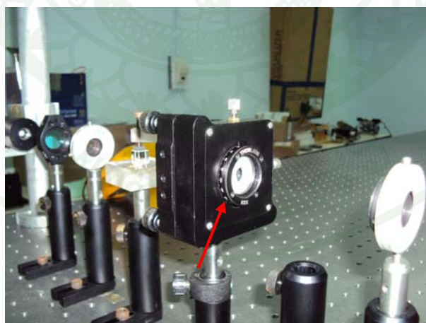
ภาพที่ 18 การติดตั้งแผ่นครึ่งคลื่น
