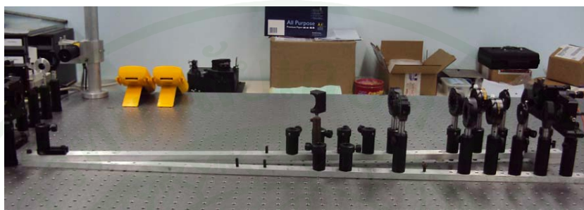
ภาพที่ 21 การติดตั้งอุปกรณ์ทางแสงที่ใช้ในการตรวจวัดโฟตอนที่พัฟฟ์
