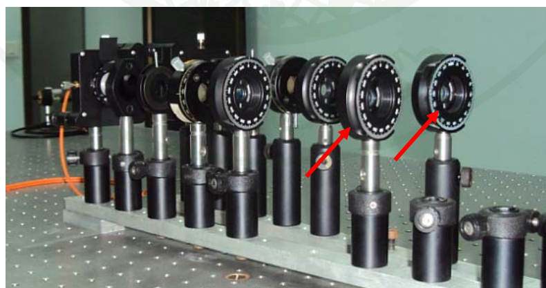
ภาพที่ 24 การติดตั้งแผ่นเลี้ยวคลื่นบนแกนออลูมิเนียม
