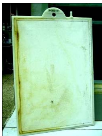
ภาพที่ 16 เมมเบรนชนิดแผ่น (flat sheet membrane) เป็นจากวัสดุ โพลีเอทิลีน(polyethylene) พื้นที่ผิว 0.1 ตารางเมตร (20x30 เซนติเมตร) ขนาดรูพรุน 0.4 ไมโครเมตร
