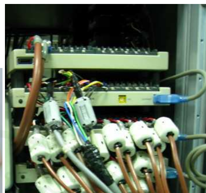
ภาพผนวกที่ 7 CADAC21-20ch adapter ใช้สแกนสัญญาณที่ได้จากเครื่อง Data Logger ซึ่งมีช่องสัญญาณอยู่ 20 ช่อง
