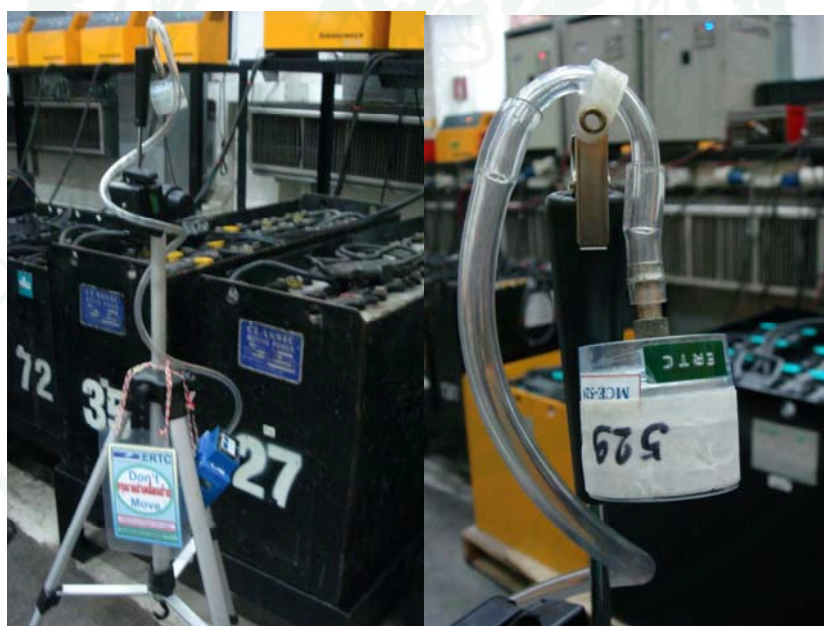
ภาพที่ 46 ลักษณะการเก็บอากาศและนำไปทดสอบหาปริมาณกรดโดยวิธี
