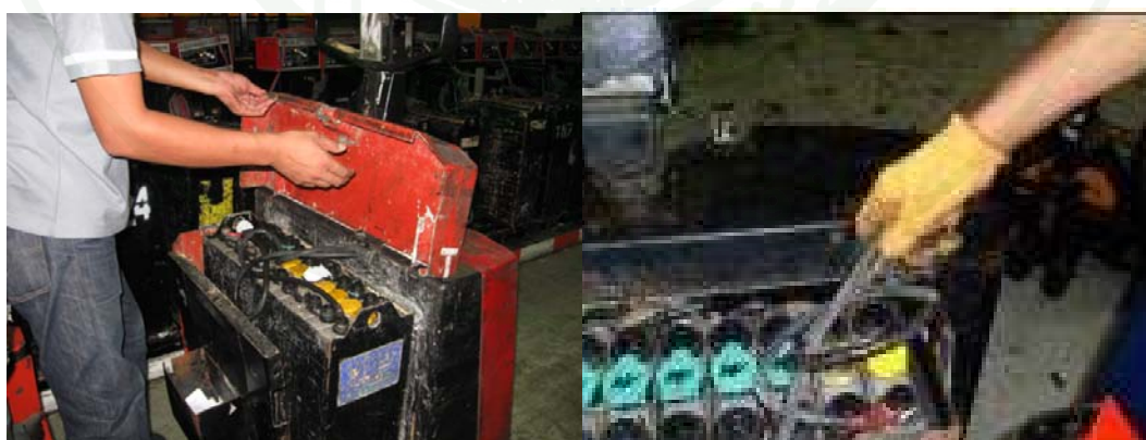
ภาพที่ 20 การเปิดฝาที่ครอบ และดึงขั้วแบตเตอรี่ออกจากรถลาก
