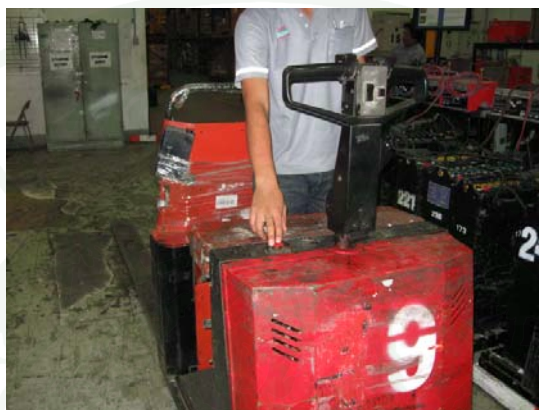
ภาพที่ 19 การจอดรถอย่างปลอดภัยโดยกดสวิทช์ฉุกเฉิน
