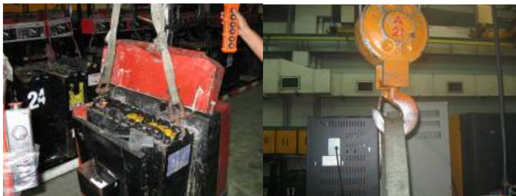
ภาพที่ 21 การใช้เครนยกแบตเตอรี่
