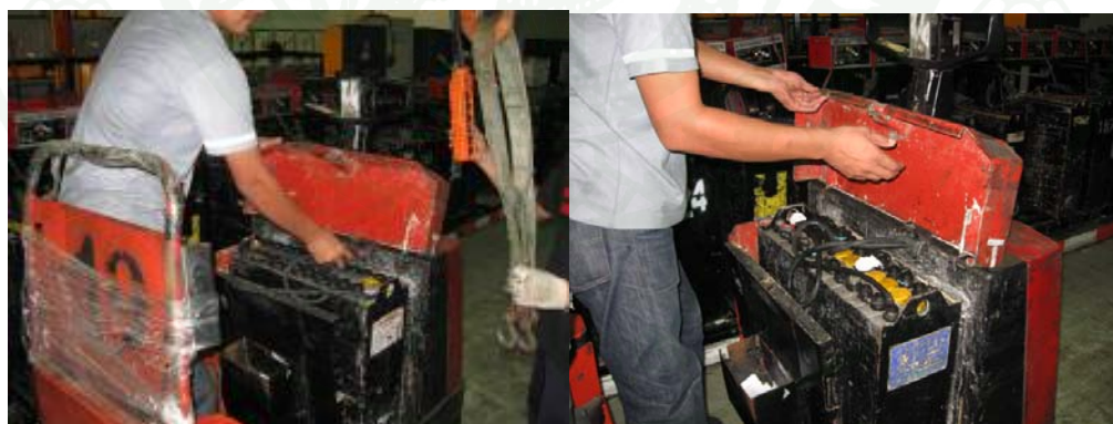
ภาพที่ 24 การเสียบปลั๊ก และ ปิดฝาที่ครอบแบตเตอรี่
