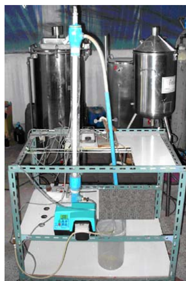
ภาพที่ 11 เครื่องปฏิกรณ์การย่อยสลายสีแบบต่อเนื่อง ประกอบด้วย (1) คอลัมน์แก้ว (2) หลอดไฟ (3) ปั๊มน้ำ (4) ปั๊มอากาศ (5) ถังป้อน (6) จุดเก็บตัวอย่าง
