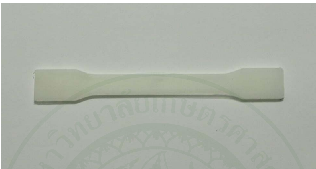
ภาพผนวกที่ 5 ลักษณะชิ้นงานที่ได้จากการออกแบบการทดลองด้วยวิธี 2^1:3^2 แฟกทอเรียล ของการทดลอง 5
