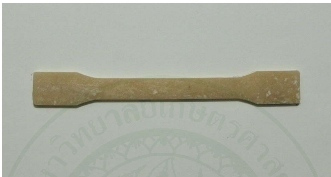
ภาพผนวกที่ ๙ ลักษณะชิ้นงานที่ได้จากการออกแบบการทดลองด้วยวิธี 2^1 \cdot 3^2 แฟลททอเรียล ของการทดลอง ๙
