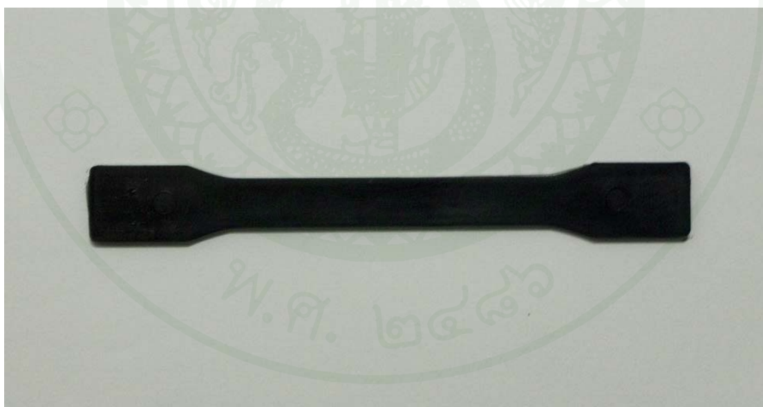
ภาพผนวกที่ ๑2 ลักษณะชิ้นงานที่ได้จากการออกแบบการทดลองด้วยวิธี 2^1 \cdot 3^2 แฟกทอเรียล ของการทดลอง 2
