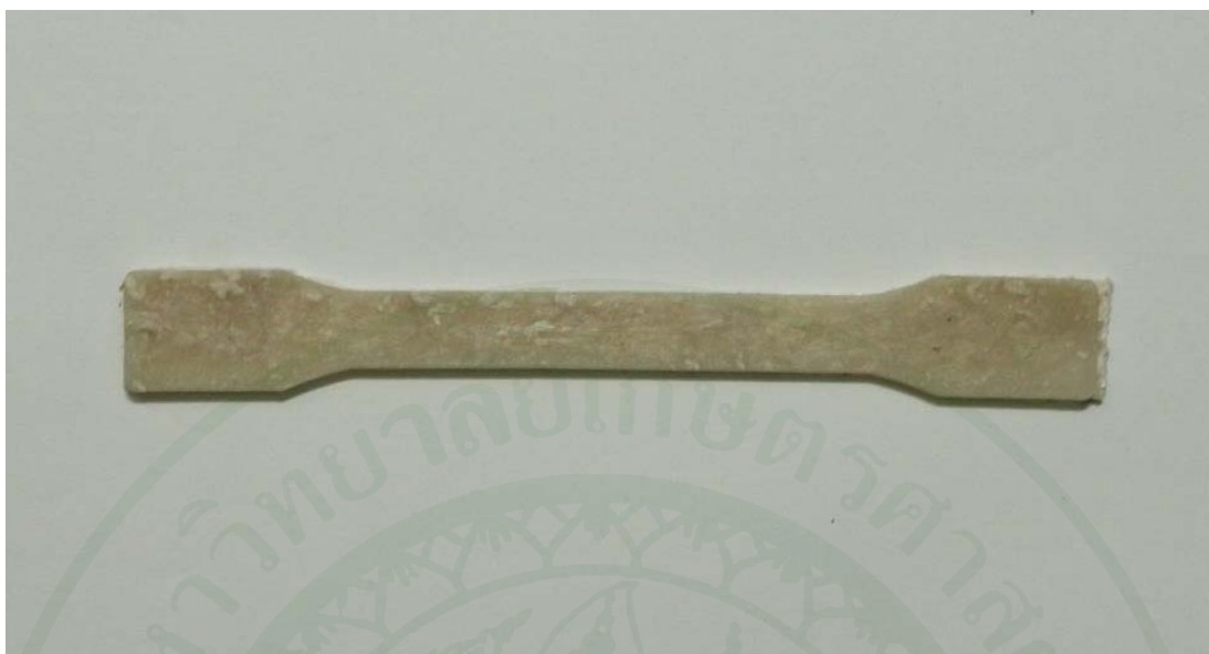
ภาพผนวกที่ 15 ลักษณะชิ้นงานที่ได้จากการออกแบบการทดลองด้วยวิธี 2^1 \cdot 3^2 แฟลททอเรียล ของการทดลอง 15
