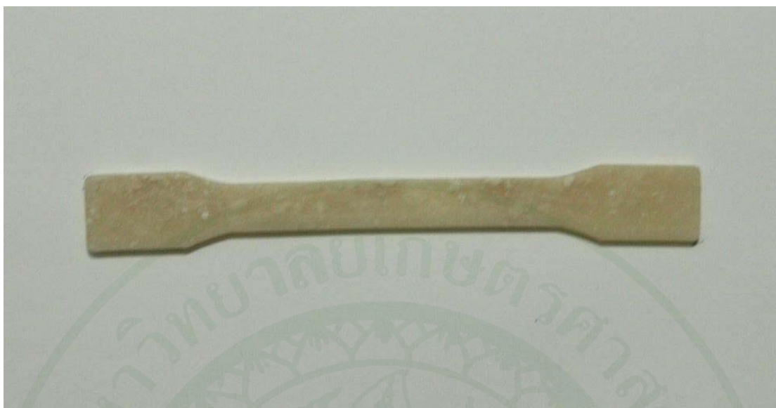
ภาพผนวกที่ ๗ ลักษณะชิ้นงานที่ได้จากการออกแบบการทดลองด้วยวิธี 2^1 \cdot 3^2 แฟลททอเรียล ของการทดลอง ๗
