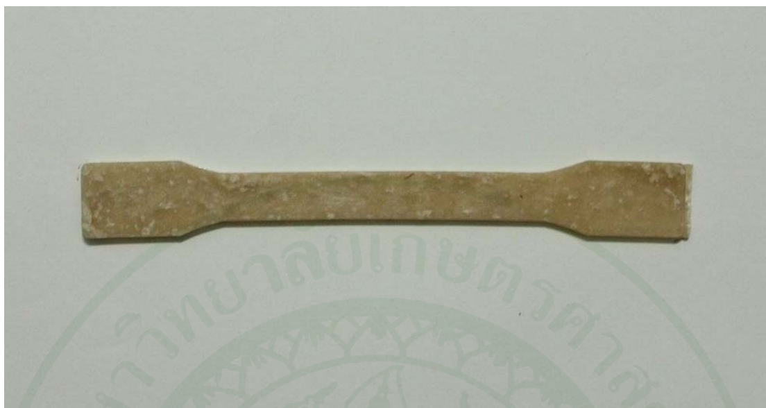
ภาพผนวกที่ 17 ลักษณะชิ้นงานที่ได้จากการออกแบบการทดลองด้วยวิธี 2^1 \cdot 3^2 แฟกทอเรียล ของการทดลอง 17
