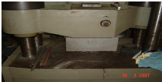
รูปที่ 13 การทดสอบความแข็งแรงของอิฐบล็อกผสมผักตบชวา 10%
