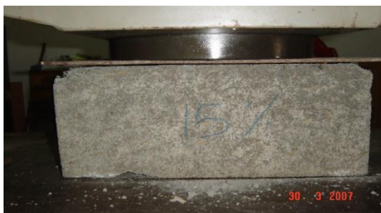
รูปที่ 14 การทดสอบความแข็งแรงของอิฐบล็อกผสมผักตบชวา 15 %
