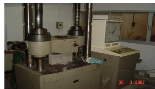
รูปที่ 12 เครื่องทดสอบ SHIMADZU MODEL UH-100A
