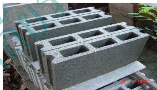
รูปที่ 21 อิฐบล็อกผสมผักตบชวา 10% ที่สามารถนำมาใช้ เป็นวัสดุก่อสร้างได้
