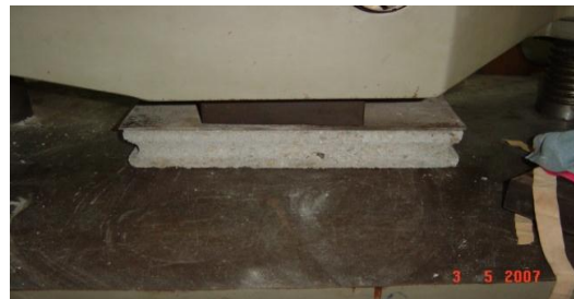
รูปที่ 17 ทดสอบความแข็งแรงของอิฐบล็อกผสมผักตบชวา 10%
