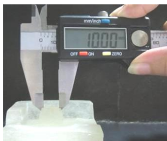
รูปที่ 3 แสดงการวัดความกว้างและยาวด้วยเวอร์เนียคาลิเปอร์
