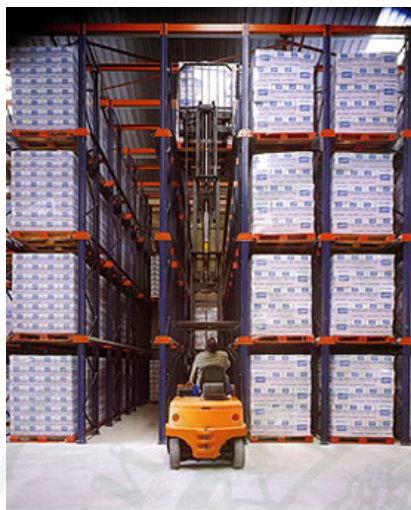
ภาพที่ 3 การจัดเก็บพาเลทสินค้าแบบ Racking และ Block stack
