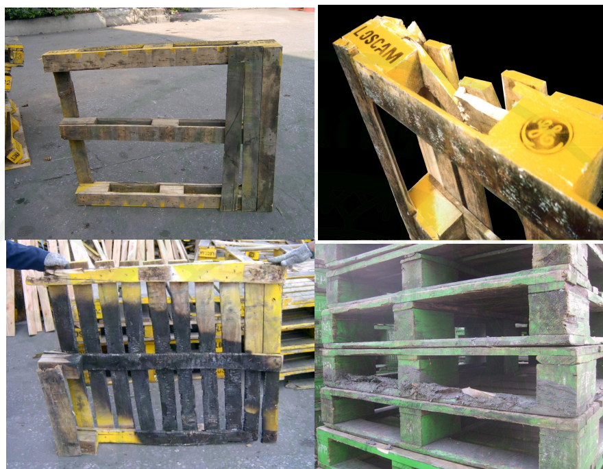
ภาพที่ 5 ลักษณะความเสียหายของพาเลทชำรุดเกินซ่อมแซม
