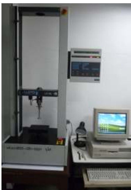
ภาพผนวกที่ 2 เครื่อง Rheometer ที่ใช้หัววัดแบบ flat plate
