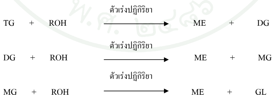
ภาพที่ 2 ขั้นตอนการเกิดปฏิกิริยาทรานเอสเทอร์ฟิเคชัน ที่มา: กรมโรงงานอุตสาหกรรม (2549)
