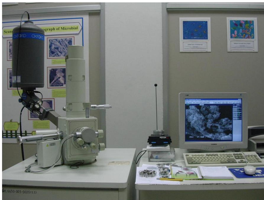
ภาพที่ 9 เครื่อง JEOL ที่ใช้ในการวิเคราะห์ SEM
