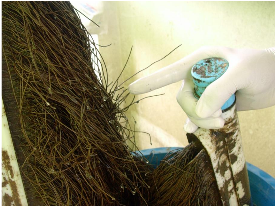
ภาพที่ 14 ลักษณะการขาดของเส้นเมมเบรน
