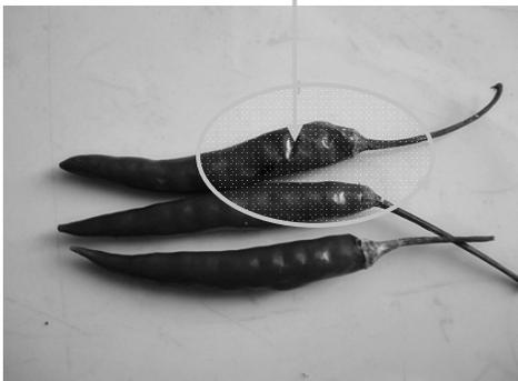
**รูปที่ 6** ตัวอย่างการเปลี่ยนแปลงลักษณะทางกายภาพของพริกชี้หนูที่หีบห่อด้วย (ก) แผ่นฟิล์มพอลิเอทิลีนธรรมดา 20 วัน (ข) แผ่นฟิล์มพอลิเอทิลีนที่มีส่วนผสมเม็ดแอลบ 30% ใช้แรงดึงฟิล์มขณะขึ้นรูป 170% เป็นเวลา 80 วัน
