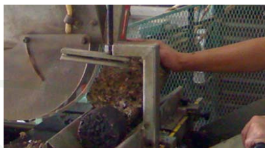
(ข) ย่อยขนาดชั้นพื้นทาง Recycling เพื่อทำการทดสอบ
