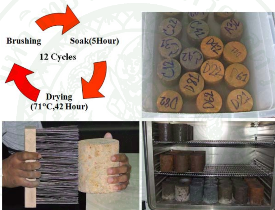
ภาพที่ 30 การทดสอบความคงทน โดยใช้ Wetting and Drying Test
