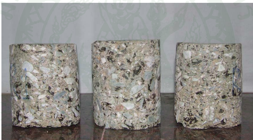
(ข) ก้อนตัวอย่างวัสดุ Recycling หลังการทดสอบ
