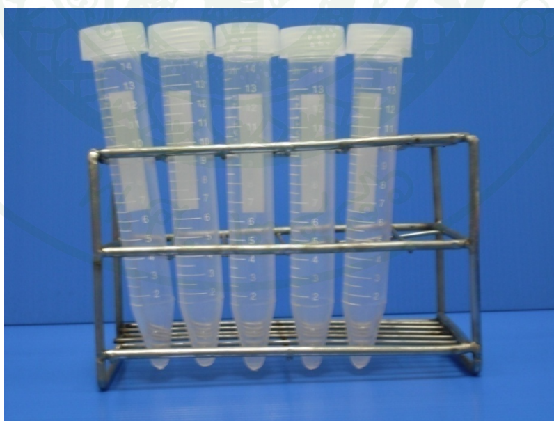
ภาพที่ 11 หลอดทดลองพลาสติกมีฝาปิดขนาด 14 ml สำหรับใส่วัตถุติด ซึ่งมีย่านเส้นผ่าน ศูนย์กลาง 1.5 cm
