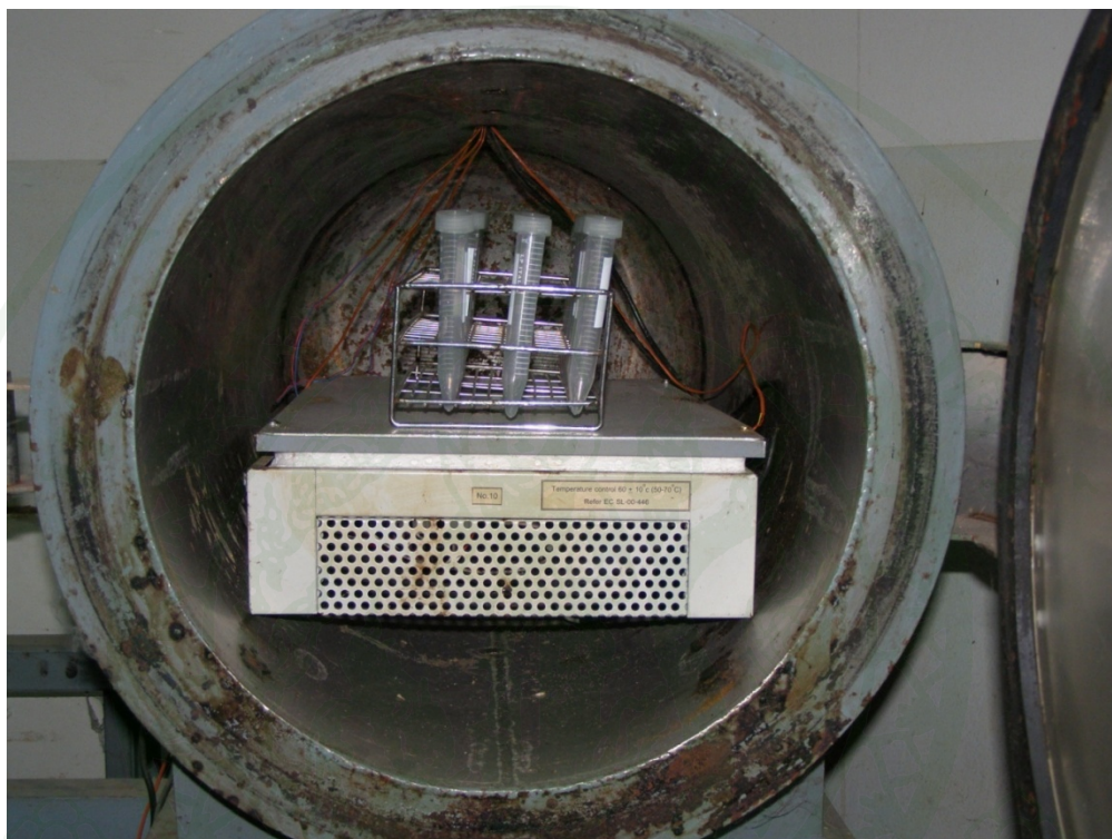
ภาพที่ 13 การวางหลอดทดลองพลาสติกใส่วัตถุในเครื่องทำแห้งแบบแช่เยือกแข็งบางส่วน
