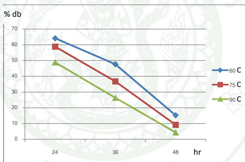
ภาพที่ 14 ความสัมพันธ์ระหว่างเปอร์เซ็นต์ความชื้นต่อน้ำหนักแห้งกับระยะเวลาในการทำแห้งแบบแช่
