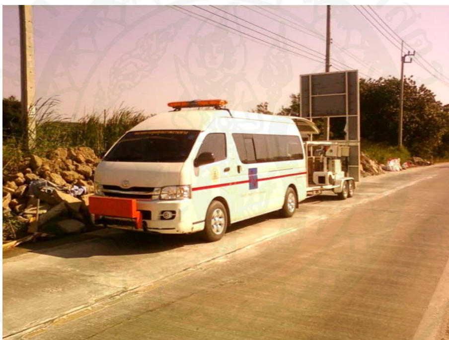
ภาพที่ 104 เครื่องมือ Falling Weight Deflectometer ของกรมทางหลวงชนบท
