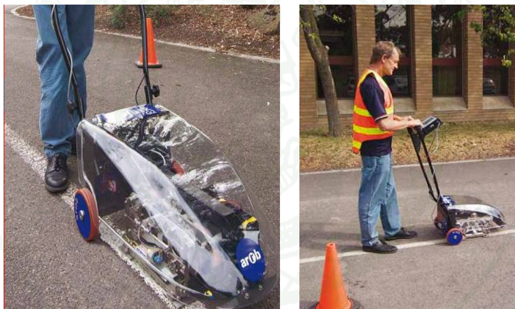
ภาพที่ 29 เครื่องมือ Walking Profiler และการใช้งาน (www.arrb.com.au)
