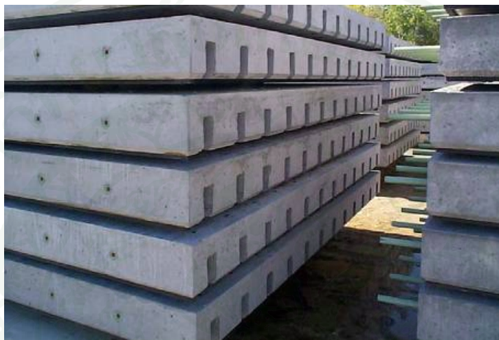
ภาพที่ 75 แผ่นคอนกรีตหล่อสำเร็จระบบ Super Slab ที่รอการขนส่งมาติดตั้งที่หน้างาน (Lacoss, 2008)
