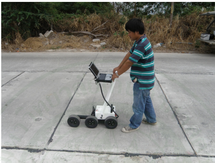
ภาพที่ 181 การตรวจวัด IRI แปลงทดสอบถนนคอนกรีตหลังการซ่อมแซม
