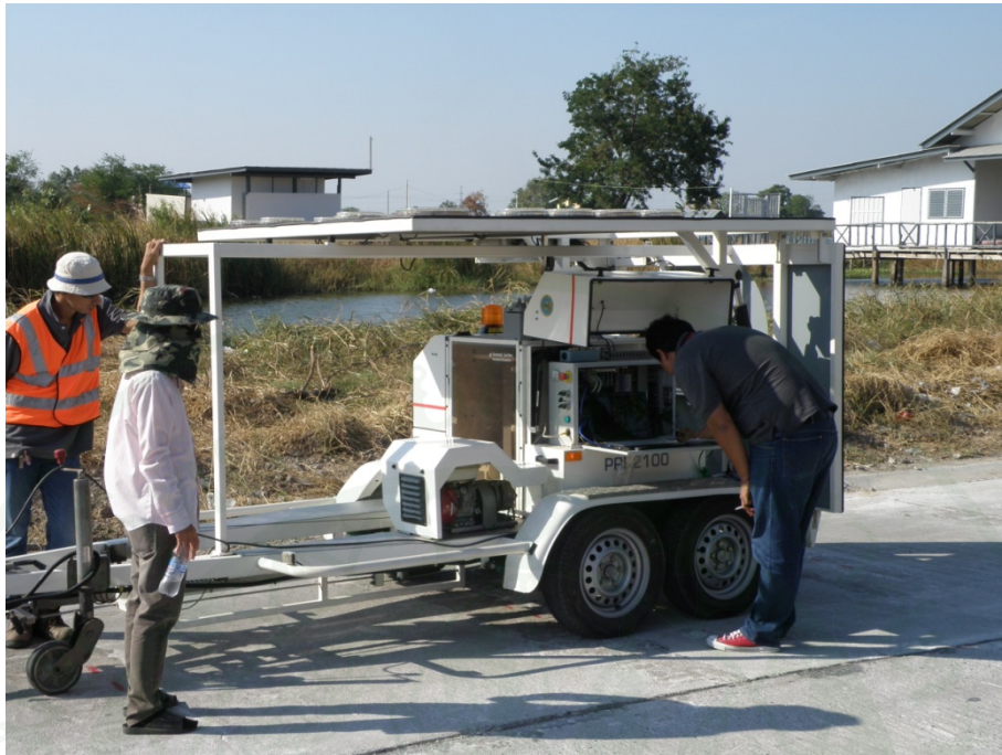
ภาพที่ 179 การทดสอบ LTE แปลงทดสอบถนนคอนกรีตด้วยเครื่องมือ FWD กรมทางหลวงชนบท
