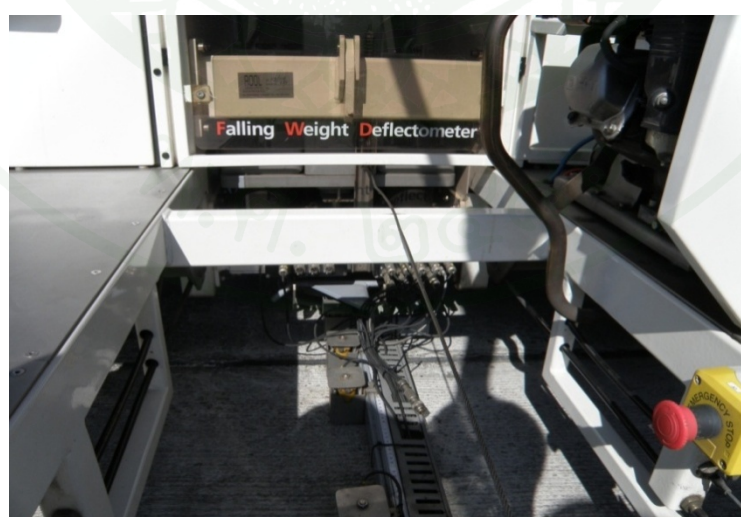
ภาพที่ 106 การตรวจวัด LTE โดยใช้ D300 กับ D400
