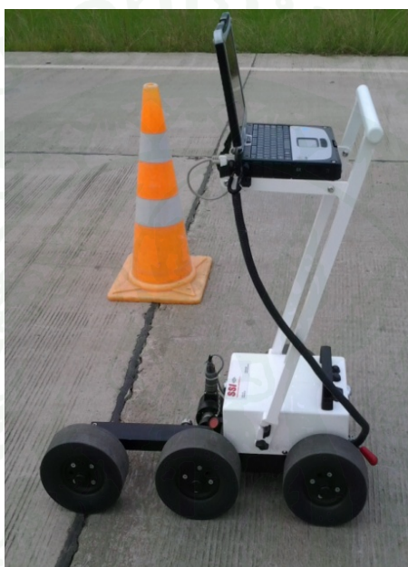
ภาพที่ 108 เครื่องมือวัด International Roughness Index (IRI)
