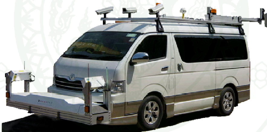
ภาพที่ 28 เครื่องวัดระดับแบบเลเซอร์ กล้องบันทึกภาพการเคลื่อนไหวและชุดเครื่องมือระบุพิกัดด้วยดาวเทียม
