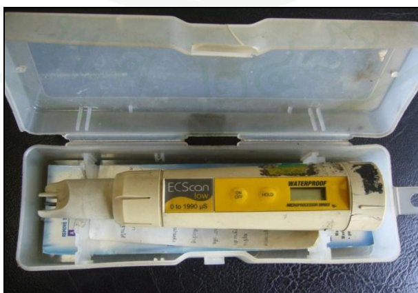
ภาพที่ 31 เครื่องวัดค่าความนำน้ำ (Conductivity Tester)
