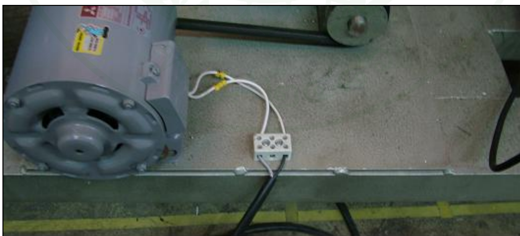
ภาพผนวกที่ ๓๙ ขั้วต่อจ่ายไฟให้กับมอเตอร์ของแกปดับอาร์ค
