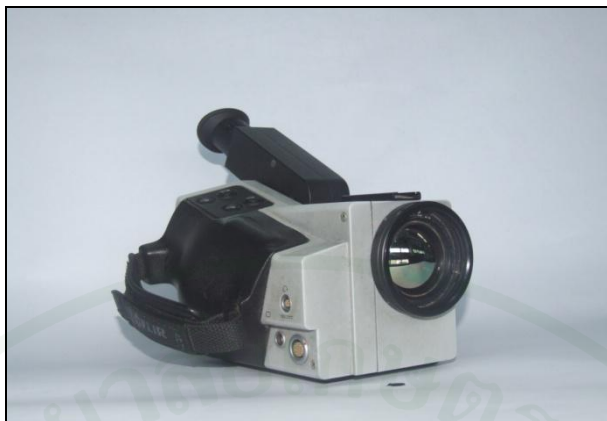
ภาพที่ 29 กล้องถ่ายภาพความร้อนหรือกล้องอินฟราเรด
