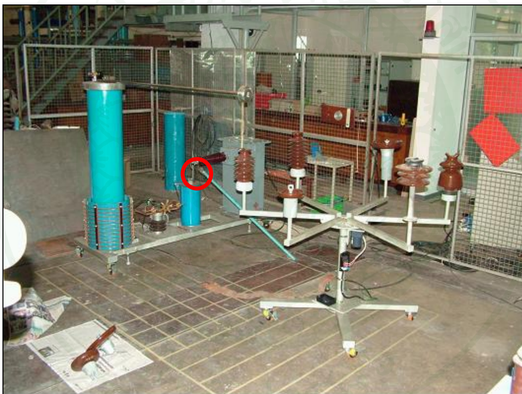
ภาพผนวกที่ น7 การจัดเรียงเครื่องกำเนิดแรงดันสูงความถี่สูงและฐานรองรับลูกถ้วย
