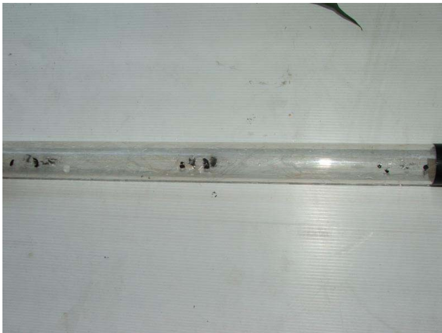
ภาพที่ 31 ตะกรันสนิมในบริเวณที่ติดตั้งสนามแม่เหล็กทั้งสามคู่
