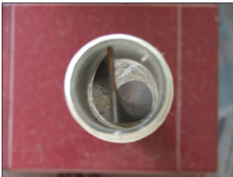
ภาพที่ 23 แสดงลักษณะแผ่นบีดที่สอดในท่ออะคริลิก
