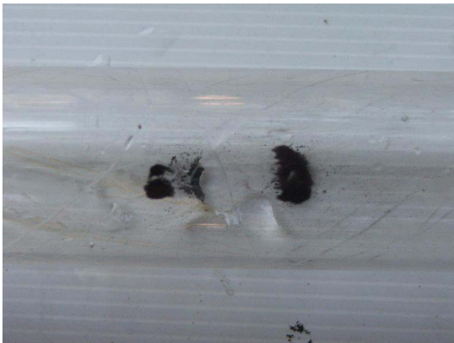
ภาพที่ 32 ตะกรันสนิมในท่ออะคริลิก
