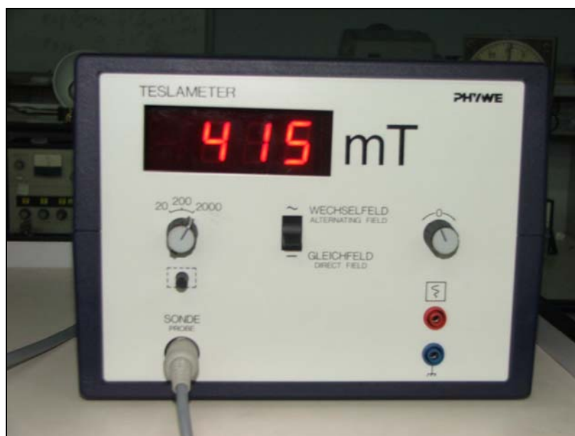
ภาพที่ 14 การแสดงค่าความเข้มของสนามแม่เหล็กที่วัดได้
