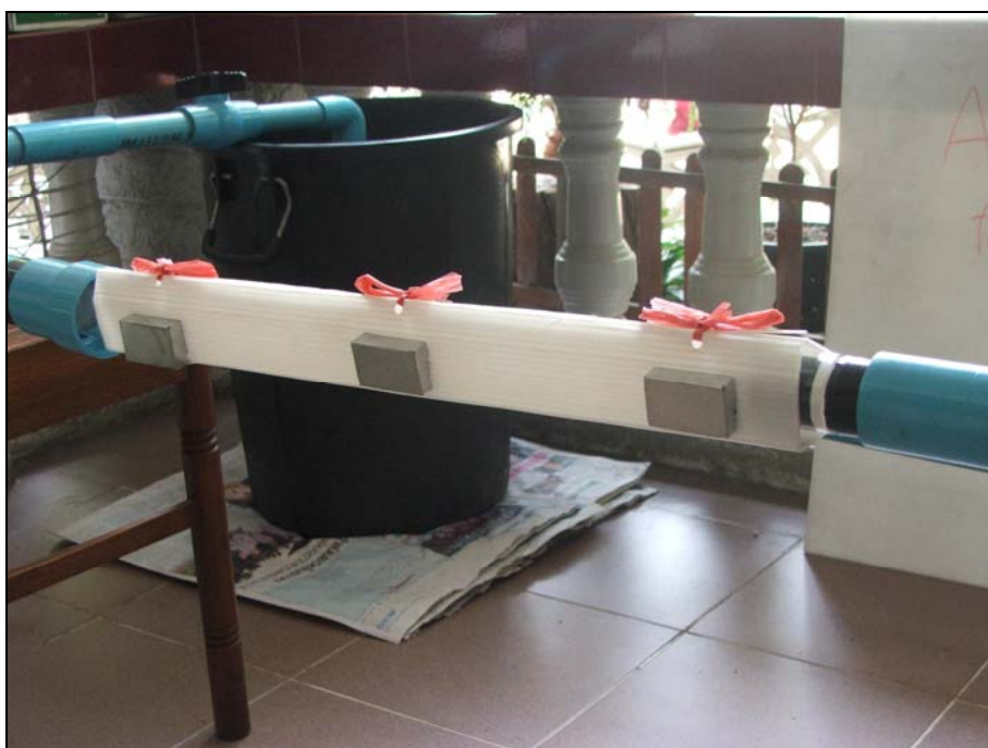
ภาพที่ 16 ชุดสนามแม่เหล็กที่ติดตั้งในระบบหมุนเวียนน้ำ
