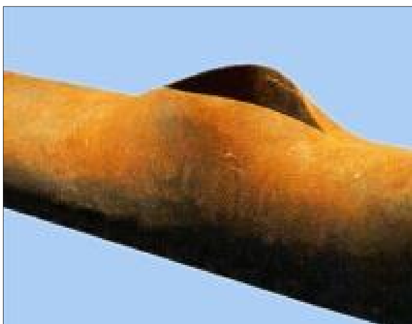
ภาพที่ 2 สภาพความเสียหายของท่อภายในหม้อไอน้ำอันเนื่องมาจากตะกอนที่เกาะจับผิวท่อภายใน ทำให้การถ่ายเทความร้อนไม่สามารถทำได้ตามปกติท่อจึงเกิดระเบิดเสียหาย
