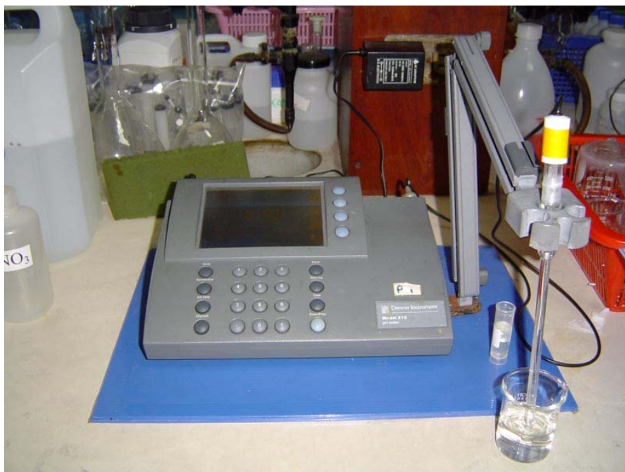
ภาพที่ 30 การวัดค่าความเป็นกรด-ด่าง ด้วย pH-Meter
